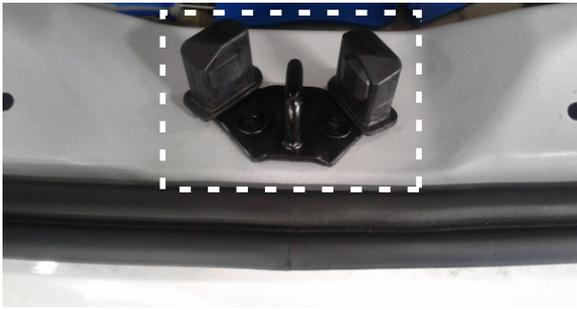
**ВНИМАНИЕ!** Перед выполнением работ убедитесь, что при закрытых боковых дверях с поднятыми в них стеклах, дверь багажника закрывается без прикладывания усилий. В противном случае необходимо её отрегулировать.
