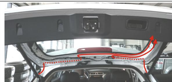
12. Проложите кабели питания электрических приводов внутрь двери и подключите их к разъемам (H, I, J) блока управления.
