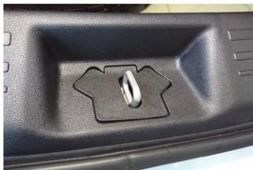
24. Замените декоративную накладку петли замка двери багажника на накладку (20) из комплекта.
