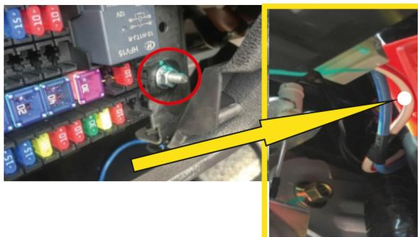
22. С помощью коннектора (7) произведите подключение кабеля питания с предохранительной колодкой (14) к БЕЛый-КРАСНый проводу +12В за блоком предохранителей.
