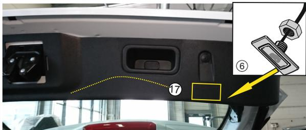
23. Фрезой (13) из комплекта просверлите отверстие 16мм в штатной заглушке обшивки задней двери, установите в неё кнопку управления (6) зафиксировав её креплением из комплекта поставки, затем подключите разъём к разъёму соединительного кабеля звукового излучателя и кнопки управления (17)
