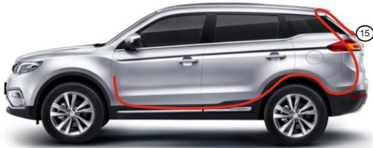
17. Демонтируйте декоративные обшивки порогов водительской стороны салона а/м. Уложите соединительный кабель питания блока управления (15) вдоль штатной проводки а/м в направлении левой части торпедо, фиксируя пластиковыми стяжками по всей длине кабеля с промежутками 150-200 мм.
