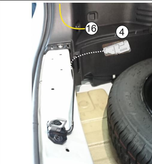
16. Установите моторизованную петлю плавного закрывания (4) из комплекта поставки. Исполнительное устройство, передающее поступательное движение петле посредством перемещения троса в защитной рубашке, расположите за левой декоративной обшивкой багажного отделения. Подключите разъемы кабеля (16) к разъему устройства.
