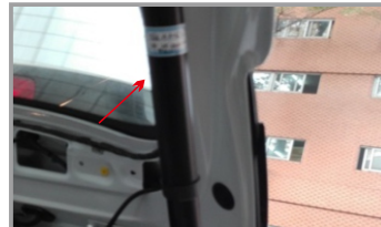
11. Присоедините электропривод к шарообразным кронштейнам соблюдая маркировку «L/R»
