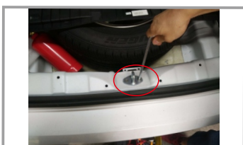
21. Демонтировать штатную петлю замка задней двери
