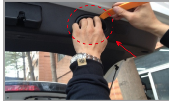
6. Демонтируйте ручку закрытия задней двери
