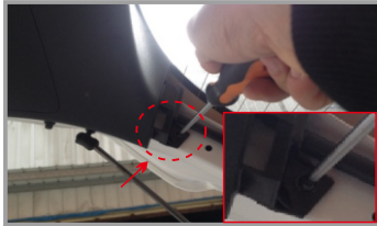
5. Открутите саморезы обшивки задней двери
