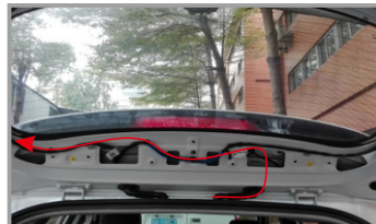
18. Проведите кабель питания к блоку управления через правый проход задней двери и подключите его разъемы
