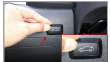
16. Фрезой из комплекта просверлите отверстие, установите в него кнопку управления и подключите разъем
