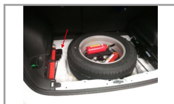
22. Вместо штатной петли установите привод "дожима" замка задней двери
