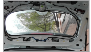
8. Демонтируйте обшивку задней двери
