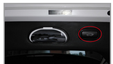
24. Установите кнопку управления (из комплекта) в штатное место и подключите к ней разъем
