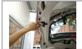
10. Замените штатные шарообразные кронштейны задней двери на кронштейны из комплекта поставки из комплекта
