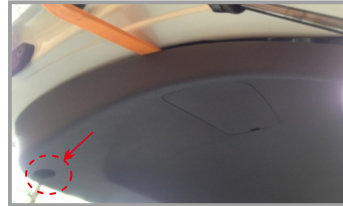
7. Открутите саморезы обшивки задней двери.
