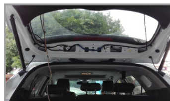
23. Установите обшивку задней двери предварительно удалив заглушку для установки кнопки управления
