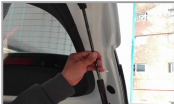
9. Демонтируйте штатные газовые упоры
