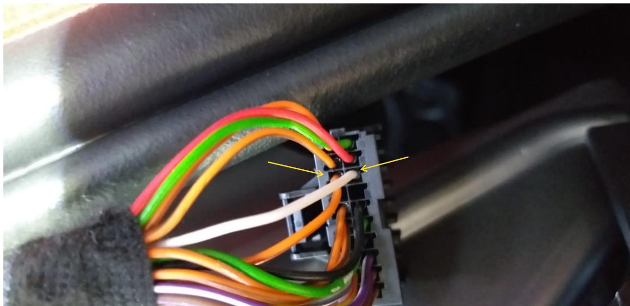
При установке 4-датчиковой системы помощи при парковке AVILINE MP-117(118)-Y4, установленной в переднем бампере а/м, при наличии штатного ассистента парковки в заднем бампере подключение CANA-PRO производится в левом заднем крыле, в месте установки блока штатного ассистента парковки согласно инструкции из комплекта CANA-PRO.
