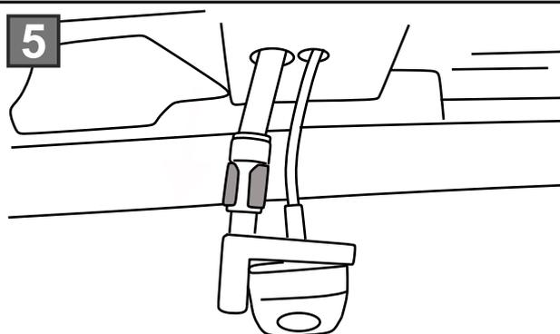
Соедините штуцер трубки с омывателем до характерного щелчка и начните прокладку трубки и кабеля камеры внутрь двери багажника.
