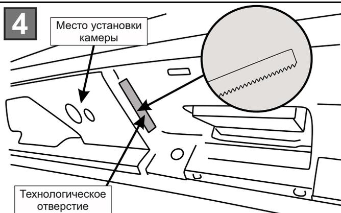
Демонтируйте штатную декоративную заглушку кнопки открытия багажника. Прodelайте технологическое отверстие для фиксации камеры для обеспечения возможности фиксации камеры.
