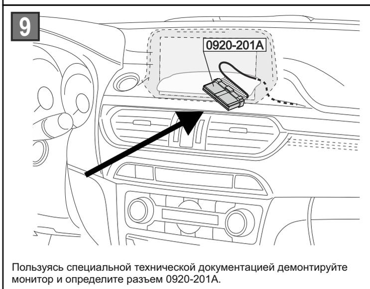
9 Пользуясь специальной технической документацией демонтируйте монитор и определите разъем 0920-201A.
