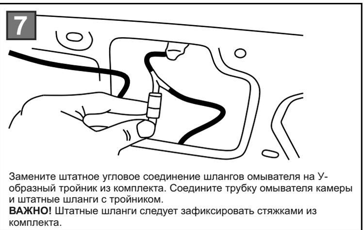
7 Замените штатное угловое соединение шлангов омывателя на У-образный тройник из комплекта. Соедините трубку омывателя камеры и штатные шланги с тройником.
