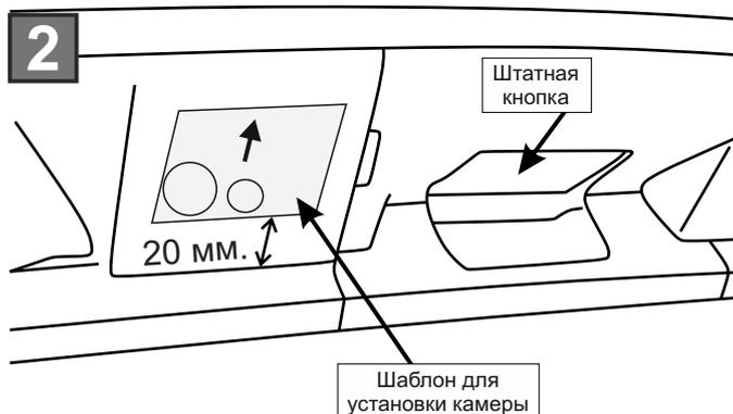
Определите места сверления, спозиционировав шаблон из комплекта. Просверлите отверстие 8 мм. для фиксации камеры и 12 мм. для трубки омывателя.
