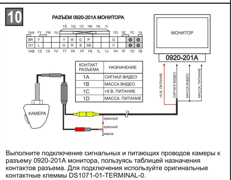
10 Выполните подключение сигнальных и питающих проводов камеры к разъему 0920-201A монитора, пользуясь таблицей назначения контактов разъема. Для подключения используйте оригинальные контактные клеммы DS1071-01-TERMINAL-0.
