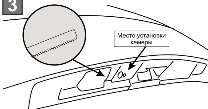
Удалите внутреннюю пластиковую технологическую перегородку через отверстие в месте установки штатного плафона подсветки номера.
