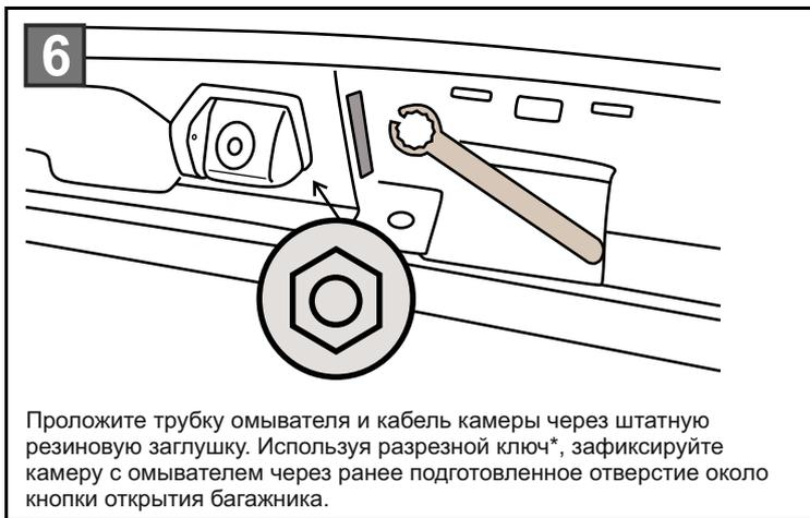
6 Проложите трубку омывателя и кабель камеры через штатную резиновую заглушку. Используя разрезной ключ\*, зафиксируйте камеру с омывателем через ранее подготовленное отверстие около кнопки открытия багажника.
