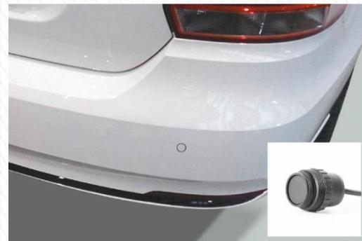
**Датчик внутренней установки в бампере**
