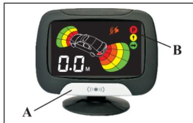
Жидкокристаллический дисплей демонстрирует расстояние до объекта при помощи цифр. Цветная шкала показывает степень приближения к препятствию для каждого датчика в отдельности. Кнопкой “А” можно отключить контроль передних датчиков.
