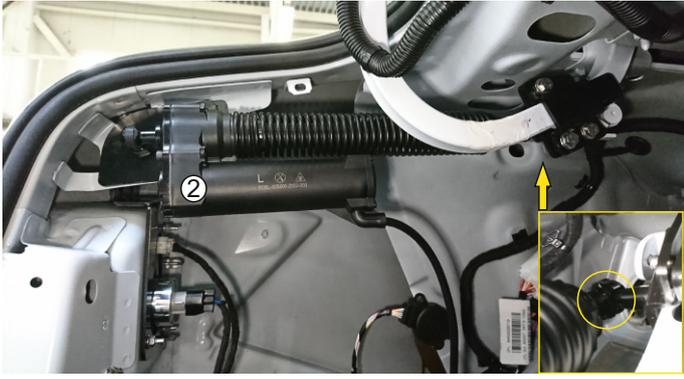
7. Присоедините электроприводы (2), к установленным шарообразным кронштейнам, как показано на фото.
