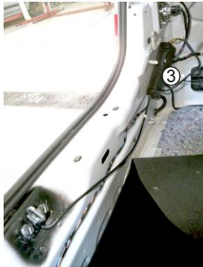
8. Установите моторизованную петлю плавного закрывания (3) из комплекта поставки. Исполнительное устройство, передающее поступательное движение петле посредством перемещения троса в защитной рубашке, расположите за левой декоративной обшивкой багажного отделения. Подключите к разъемам устройства соединительный кабель (13)
