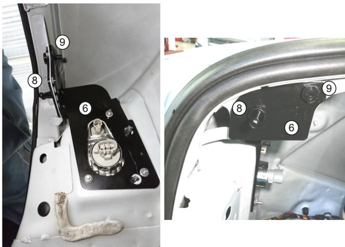
5. Закрепите элемент кронштейна (6) из комплекта на шпильки крепления заднего левого фонаря. Соедините элементы кронштейна крепежом (9). В получившуюся конструкцию установите шарообразный кронштейн (8)
