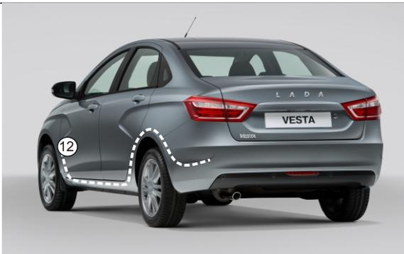
15. Демонтируйте декоративные обшивки порогов водительской стороны салона а/м. Уложите соединительный кабель питания блока управления (12) вдоль штатной проводки а/м в направлении левой части торпеды, фиксируя пластиковыми стяжками по всей длине кабеля с промежутками 150-200 мм.
