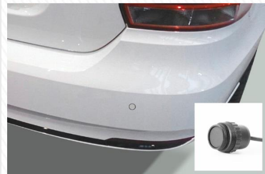
Датчик внутренней установки в бампере Позволяет сохранить оригинальный внешний вид бампера. Регулировка величины выступающей части под любую толщину тела бампера.
