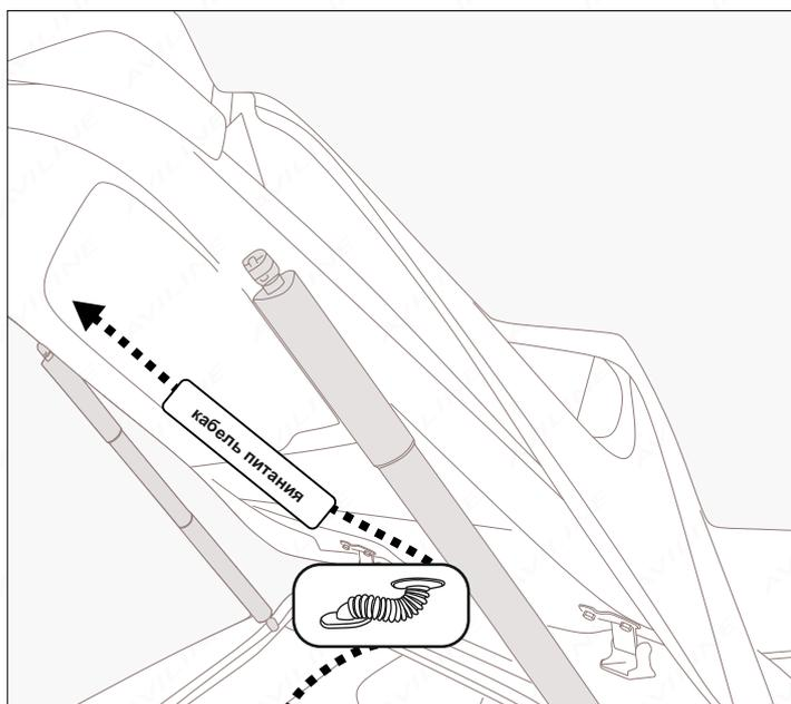
14. Проведите кабель питания блока управления из салона а/м в дверь багажника, через штатный резиновый переход в верхней части проема багажника.
