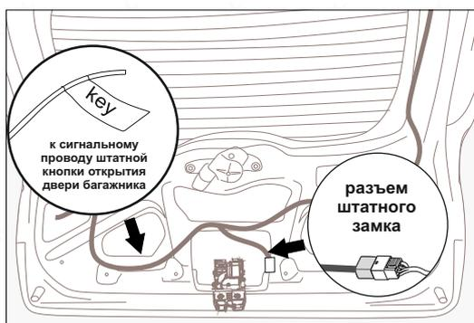
13. Подключите соответствующий кабель, к разъему "J" блока управления, затем подключите разъем кабеля от штатного замка багажника и выполните подключение **ЗЕЛЕНОГО** провода «KEY» к штатному сигнальному проводу штатной кнопки открытия двери багажника.
