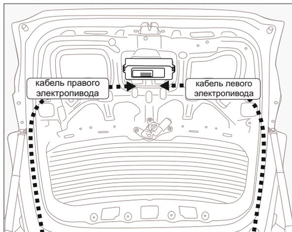
8. Закрепите блок управления внутри корпуса двери багажника, используя элементы крепления из комплекта.
