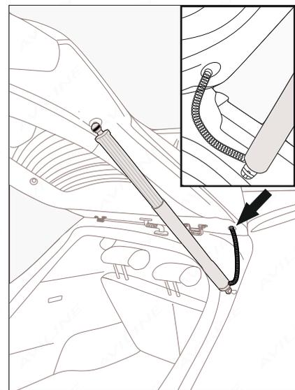
5. Присоедините электроприводы, соблюдая маркировку «L» и «R», к установленным шарообразным кронштейнам, таким образом, чтобы место из которого выходит кабель находилось ближе к кронштейну, расположенному на кузове автомобиля.
