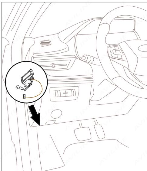
22. При отсутствии штатной кнопки открытия багажника, выберите место для установки кнопки управления, слева от руля. Просверлите отверстие Ø3мм, а затем расширьте это отверстие фрезой из комплекта Ø16мм. Установите кнопку в сформированное отверстие.
