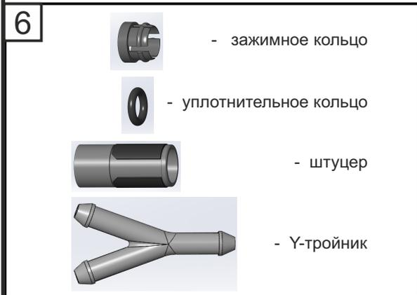
Заделать концы разрезанной трубки штуцерами согласно методике, показанной на Рис. 7:
