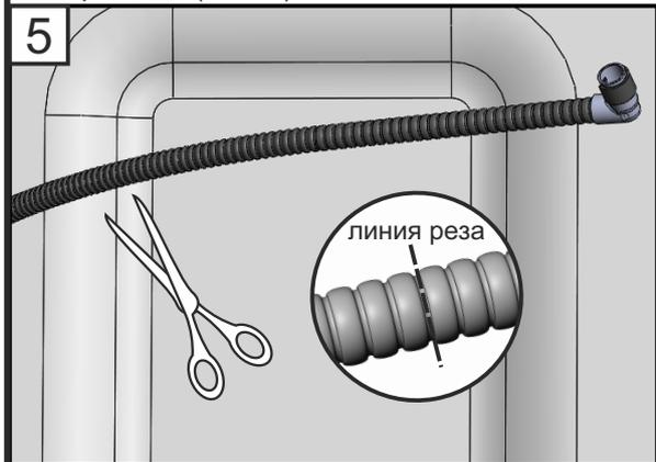
В месте разреза водяной магистрали выполнить её разветвление при помощи элементов комплекта (Рис.6):
