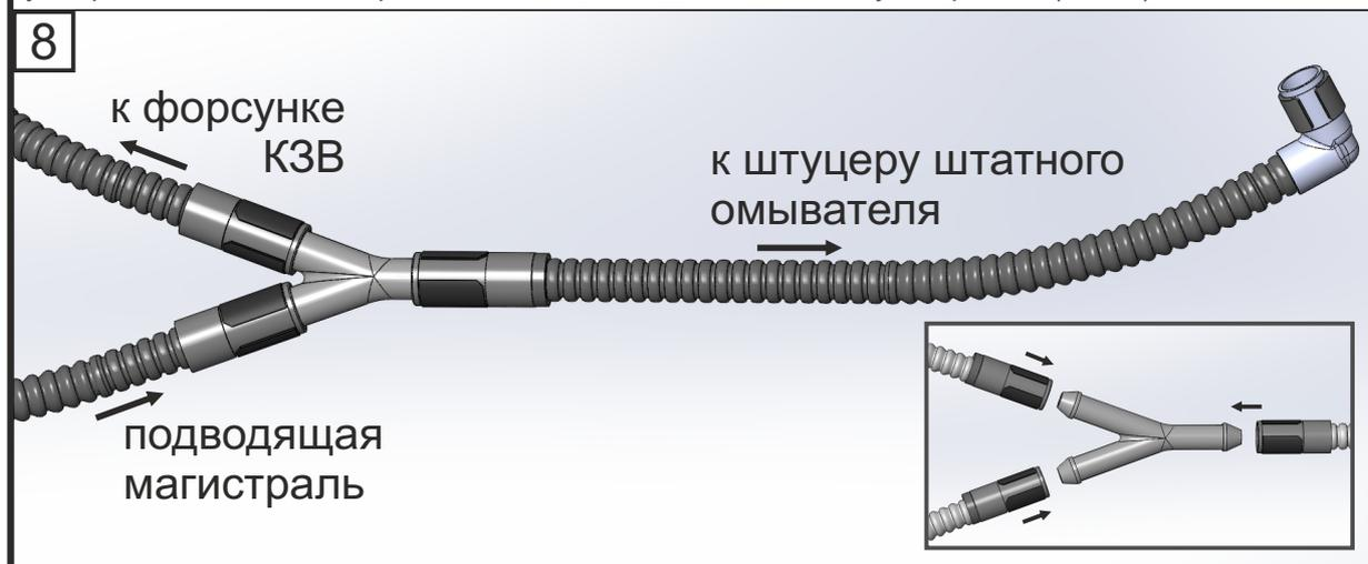
Вернуть обратно через полость в металле штатный штуцер и подключить к штатному омывателю. Трубку подключения к форсунке КЗВ продеть в отверстие корпуса разъемов и проложить к КЗВ.
