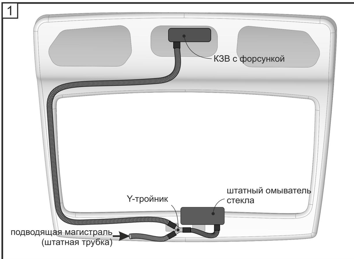
Место врезки в водяную магистраль штатного омывателя находится в верхней части крышки багажника. Для доступа необходимо снять декоративную облицовку (Рис. 2):
