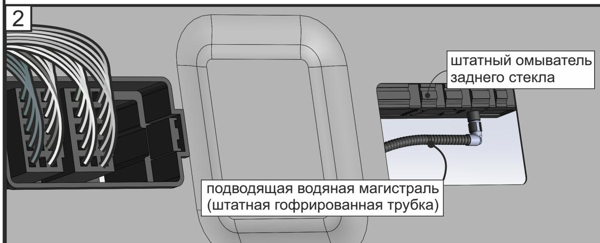
Отсоединить подводящий штуцер от штатного омывателя (Рис.3):
