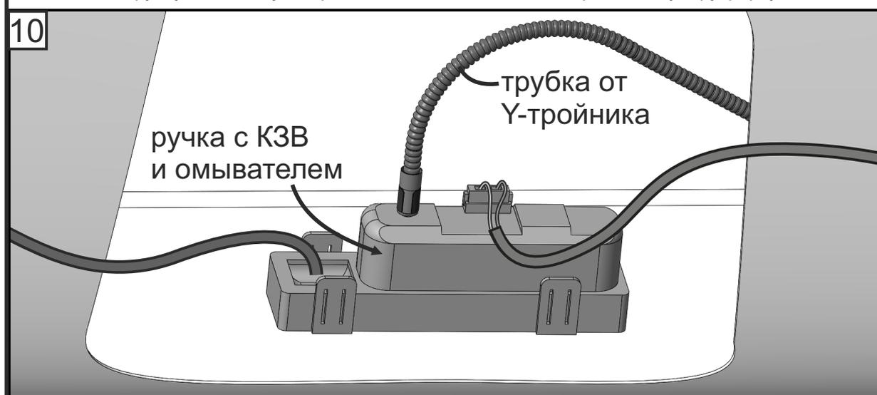
12. Перед сборкой автомобиля проверить герметичность всех выполненных соединений, работоспособность кнопки открытия багажника, камеры и её омывателя.
