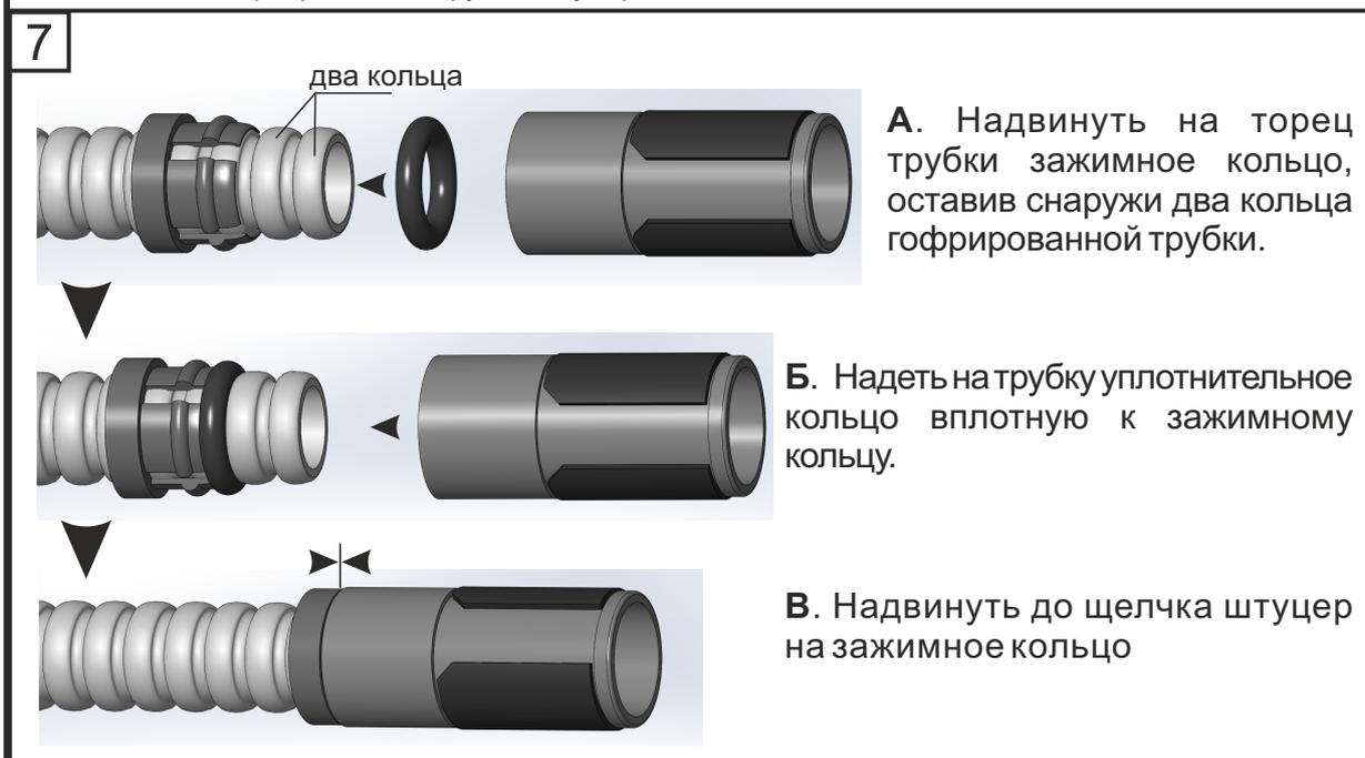
Отрезать гофрированную трубку из комплекта длиной, достаточной для подключения к форсунке КЗВ. Заделать оба конца трубки штуцерами. Защитить трубку матерчатой изоляцией. Собрать узел разветвления магистрали омывающей жидкости, используя Y-тройник (Рис. 8):
