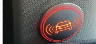
При попадании объекта в зону действия радаров, система оповещает водителя световым индикатором и звуковым сигналом.
