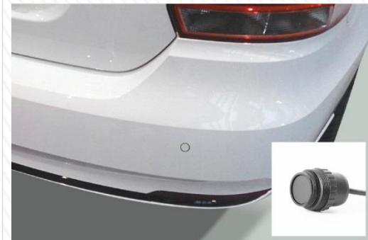
**Датчик внутренней установки в бампере**
