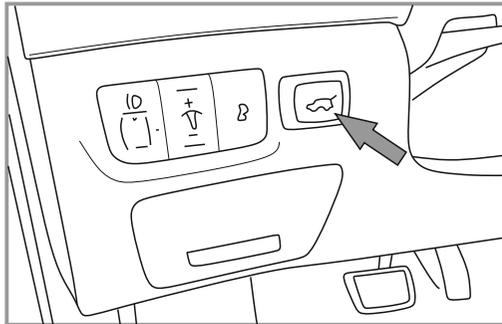
10. Используя фрезу из комплекта просверлите отверстие в торпедо для кнопки управления. Установите кнопку управления в сформированное отверстие. Подключите соответствующий разъем питающего кабеля к кнопке управления.
