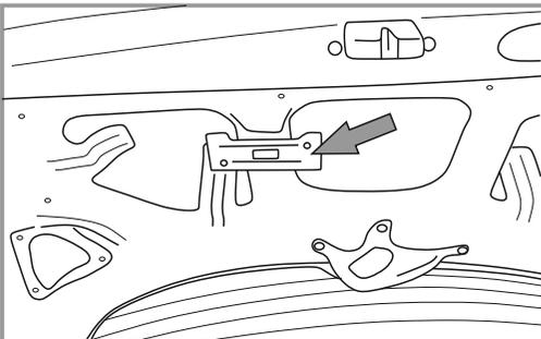
7. Закрепите блок управления на металлической перегородке в левой части задней двери, используя крепежную пластину. Подсоедините кабель к разъёмам В и D.
