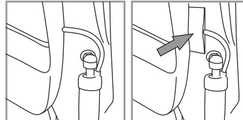
17. Установите на место декоративную обшивку двери и определите местоположение кабелей электроприводов. Для них необходимо сделать вырезы округлой формы в декоративной обшивке задней двери и установить на кабели резиновые адаптеры из комплекта поставки. После чего приклеить эти адаптеры на металлическую поверхность двери при помощи двухсторонней клейкой ленты.
