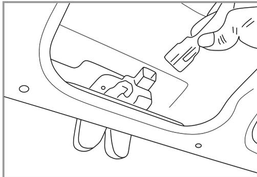
13. Осуществите подключение разъёмов устройства в разрыв кабеля штатной кнопки открытия двери багажника и кабеля замка задней двери. При не совпадении разъёма, для подключения к штатной кнопке открытия задней двери, подключите ЗЕЛЕНый провод кабеля устройства к белому проводу штатной кнопки открытия замка задней двери. **ВАЖНО!** Перед подключением провода необходимо свериться со схемой электрооборудования а/м.
