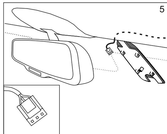
6. Подсоедините разъем установленного кабеля к соответствующему разъему устройства. Закрепите устройство на установленном держателе (Рис. 6).
