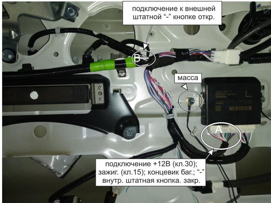
**A** Подключения к +12В (клемма30), к зажиганию (клемма15), к концевикам багажника, к "-" штатной внутр. кнопки закрытия. Масса - под штатный болт крепления блока.
