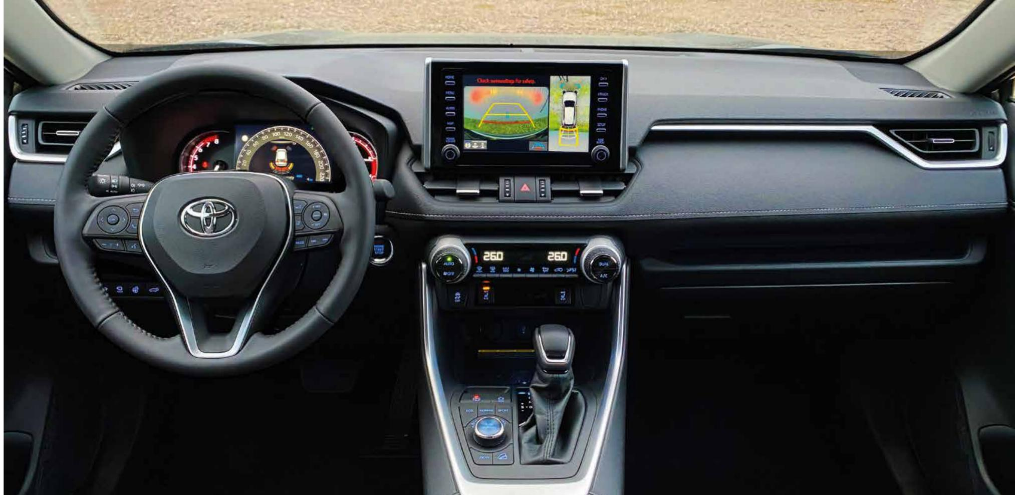
Индикация системы помощи при парковке CANA-PRO на дисплее приборной панели и мониторе штатной информационно-развлекательной системы
