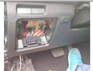
16. Фрезой из комплекта просверлите отверстие, и установите в него кнопку управления и подключите разъем
