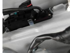
19. Подключите «проходным» кабелем штатную кнопку открытия задней двери
