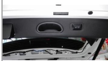
22. Фрезой из комплекта просверлите отверстие, установите в него кнопку управления и подключите разъем
