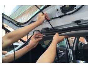
18. Проведите питающий кабель внутрь задней двери через резиновый проход в верхней части проёма и подключите его разъемы к блоку управления.
