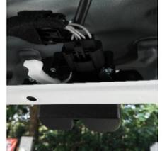
20. Подключите «проходным» кабелем штатный электрический замок задней двери
