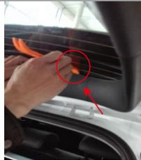
3. Демонтируйте центральную часть обшивки задней двери
