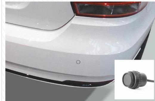
**Датчик внутренней установки в бампере**
