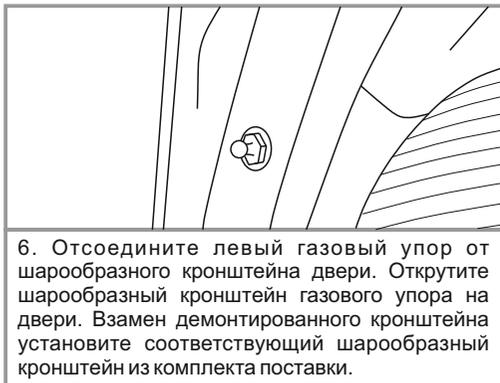
6. Отсоедините левый газовый упор от шарообразного кронштейна двери. Открутите шарообразный кронштейн газового упора на двери. Взамен демонтированного кронштейна установите соответствующий шарообразный кронштейн из комплекта поставки.
