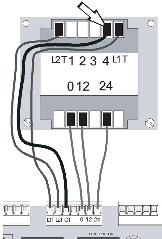
Для изменения усилия привода переключить клемму, обозначенную на рисунке, в одну из четырех позиций (1 - мин., 4 - макс.)
