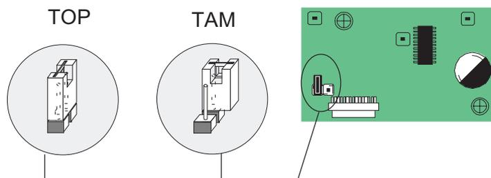
Для брелков-передатчиков серии TOP должна быть установлена перемычка на плате радиоприемника AF43S
