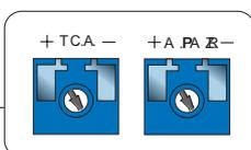
**Триммер Т.С.А.** - регулировка времени автоматического закрывания (от 1 до 150 с).
