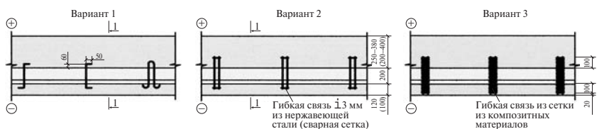
Рис. 10.1.1 Схема установки одиночных нерегулируемых гибких связей с анкерровкой в горизонтальных растворных швах
