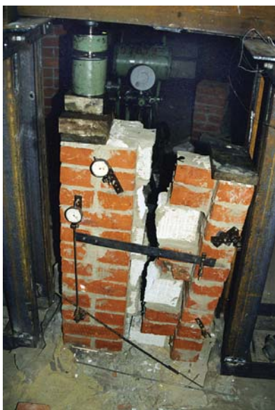
Рис. 5.2.13 б. Неармированный образец I-го типа после испытания на сдвиг
