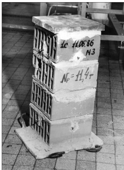
Рис. 3.4.13 Образец кладки типа I из керамических камней высотой 142 мм, с 11-ю горизонтальными пустотами после испытаний на сжатие. Испытания автора, ЦНИИСК им В.А. Кучеренко, 1986 г.
