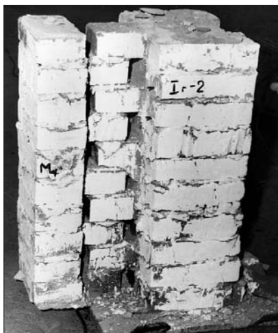
Рис. 5.2.4. Фотографии образцов кладки I-го и II-го типов. Испытания автора и инж. Е.В. Шенкаренко, ЦНИИСК, 1987 г.
