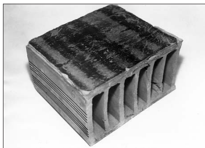
Рис. 3.4.16 Распределение вертикальных напряжений по горизонтальной поверхности кирпича (камня), полученное после обжигания кирпича (камня) в прессе с прокладкой красящей ленты между плитой прессы и образцом. Испытания автора, ЦНИИСК им Кучеренко, 1979 г
