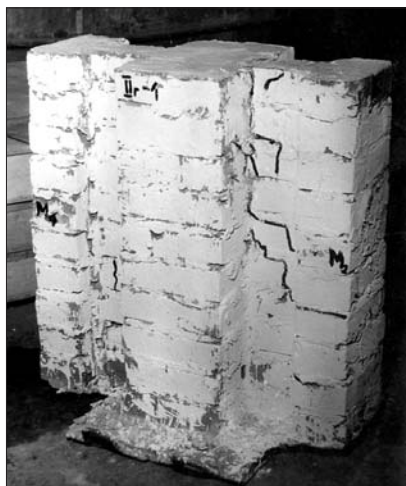
Рис. 5.2.4. Фотографии образцов кладки I-го и II-го типов. Испытания автора и инж. Е.В. Шенкаренко, ЦНИИСК, 1987 г.
