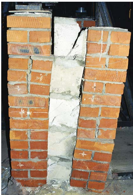
Рис. 5.2.15 а. Характер разрушения неармированных образцов II-го типа трехслойной стены с вертикальными диафрагмами из ячеистобетонных камней после испытания на сдвиг. Испытания автора и инж. А.В. Калугина, ЦНИИСК, 2003 г.
