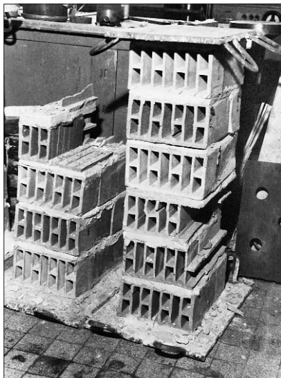
Рис. 3.4.14 Образец кладки типа II из керамических камней высотой 120 мм Норского комбината с горизонтальными пустотами (пустотность 44,6%) после испытаний на сжатие. Испытания автора, ЦНИИСК им В.А. Кучеренко, 1986 г.
