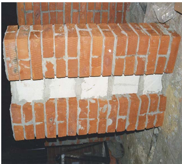
Рис. 5.2.10. Общий вид образца II-го типа трехслойной стены из кирпичной кладки с вертикальными диафрагмами из ячеистобетонных камней. Испытания автора и инж. А.В. Калугина, ЦНИИСК, 2003 г.
