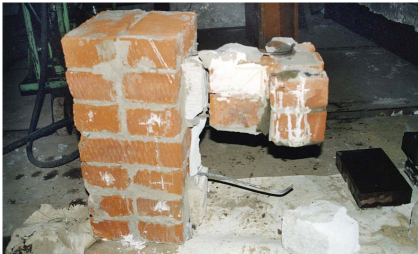
Рис. 5.2.14. Армированный образец I-го типа трехслойной стены из кирпичной кладки с вертикальными диафрагмами из ячеистобетонных камней и глиняного кирпича после испытания на сдвиг. Испытания автора и инж. А.В. Калугина, ЦНИИСК, 2003 г.
