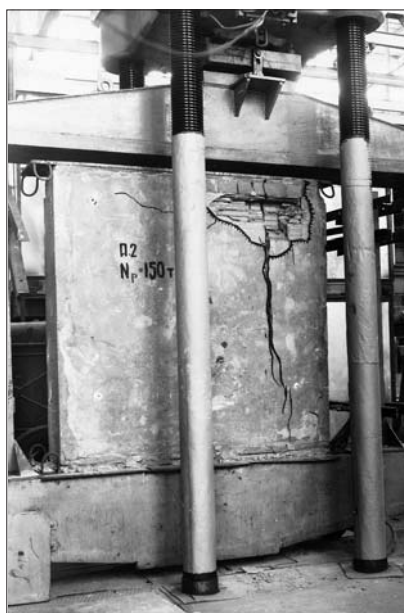
Рис. 3.4.3 Характер разрушения образца кладки П2 из шестипустотного керамического кирпича с перевязочным кирпичом с вертикальными пустотами Норского комбината. Испытания автора, 1980 г.
