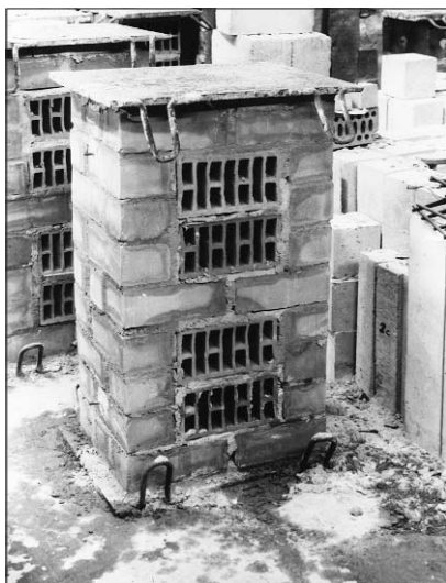
Рис. 4.2.1 б Образцы трехслойной кладки с внутренним слоем из керамических камней высотой 120 мм с горизонтальными пустотами (пустотностью 44,6%) с двухсторонней облицовкой и перевязкой с внутренним слоем керамическим кирпичом высотой 88 мм с вертикальными пустотами (пустотностью 34%), подготовленные для испытаний на сжатие. Испытания автора ЦНИИСК им. Кучеренко, 1986 г.
