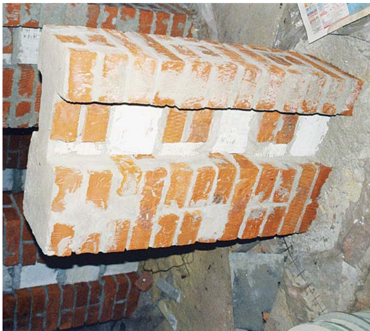
Рис. 5.2.8. Общий вид образца 1-го типа трехслойной стены из кирпичной кладки с вертикальными диафрагмами из комбинированной кладки из ячеистобетонных камней и глиняного кирпича. Испытания автора и инж. А.В. Калугина, ЦНИИСК, 2003 г.
