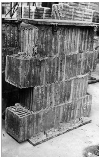
Рис. 3.3.2 Образцы кладки из керамического камня с горизонтальными пустотами для строительства Дворца Советов в Москве. Испытания В.А. Камейко, 1938 г.
