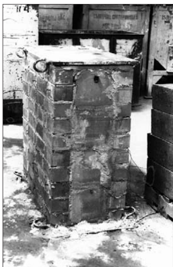
Рис. 4.3.1 Опытный образец комбинированной трехслойной кладки из керамического камня с 11-ю пустотами с внешними слоями из керамического кирпича с вертикальными пустотами, соединенными вертикальной диафрагмой из того же кирпича. Испытания автора, ЦНИИСК им. В.А. Кучеренко, 1986 г.
