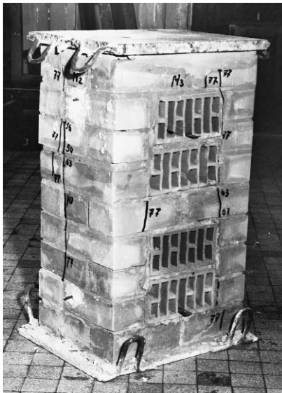
Рис. 4.2.4 а Опытные образцы трехслойной кладки с внутренним слоем из керамических камней высотой 120 мм с горизонтальными пустотами (пустотность 44,6%) с облицовкой керамическим кирпичом высотой 88 мм с вертикальными пустотами (пустотность 34%), испытанные на сжатие. Испытания автора, ЦНИИСК им. Кучеренко, 1986 г.
