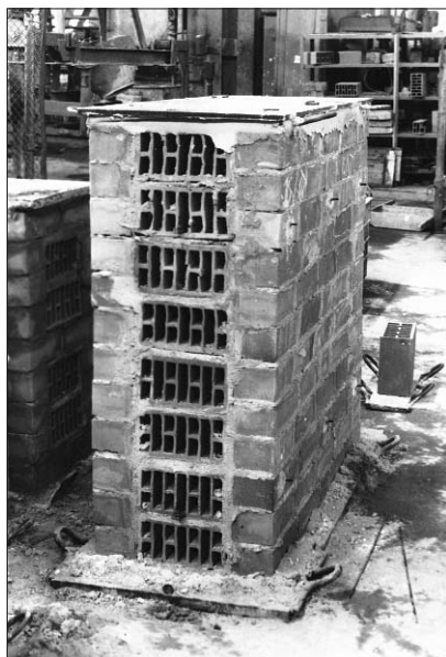
Рис. 4.2.1 в Образец комбинированной кладки из камня с 11-ю пустотами (пустотность 44,6%) с наружным слоем из кирпича с вертикальными пустотами (пустотность 34%) (тип 2). Испытания автора, ЦНИИСК им. В.А. Кучеренко, 1986 г.
