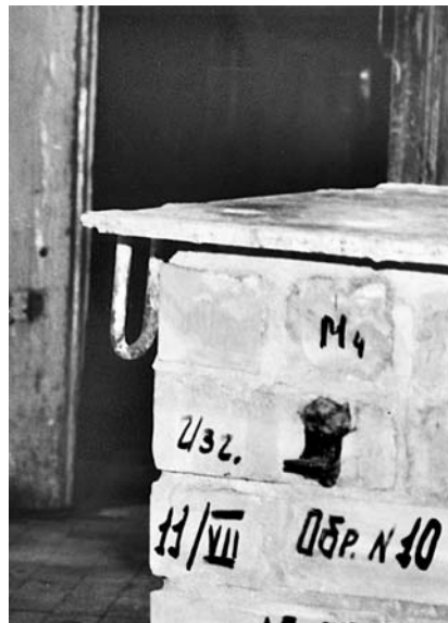
Рис. 4.2.4 б Опытные образцы трехслойной кладки с внутренним слоем из керамических камней высотой 120 мм с горизонтальными пустотами (пустотность 44,6%) с облицовкой керамическим кирпичом высотой 88 мм с вертикальными пустотами (пустотность 34%), испытанные на сжатие. Испытания автора, ЦНИИСК им. Кучеренко, 1986 г.
