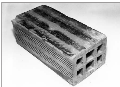
Рис. 3.4.16 Распределение вертикальных напряжений по горизонтальной поверхности кирпича (камня), полученное после обжигания кирпича (камня) в прессе с прокладкой красящей ленты между плитой прессы и образцом. Испытания автора, ЦНИИСК им Кучеренко, 1979 г
