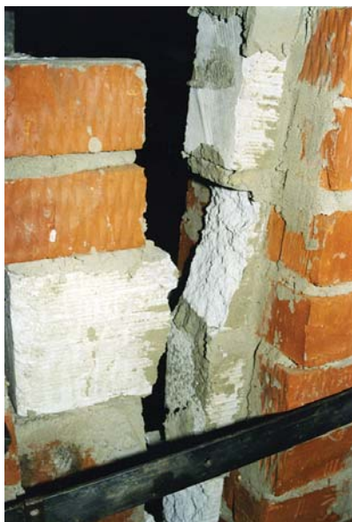
Рис. 5.2.13 а. Неармированный образец I-го типа трехслойной стены из кирпичной кладки с вертикальными диафрагмами из ячеистобетонных камней и глиняного кирпича после испытания на сдвиг. Испытания автора и инж. А.В. Калугина, ЦНИИСК, 2003 г.
