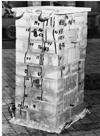
Рис. 4.2.4 а Опытные образцы трехслойной кладки с внутренним слоем из керамических камней высотой 120 мм с горизонтальными пустотами (пустотность 44,6%) с облицовкой керамическим кирпичом высотой 88 мм с вертикальными пустотами (пустотность 34%), испытанные на сжатие. Испытания автора, ЦНИИСК им. Кучеренко, 1986 г.
