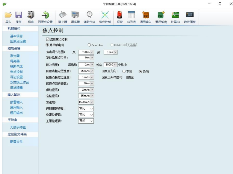
Рисунок 3.6 Значение настройки параметра фокусировки оптического соотношения VM114 100/150
