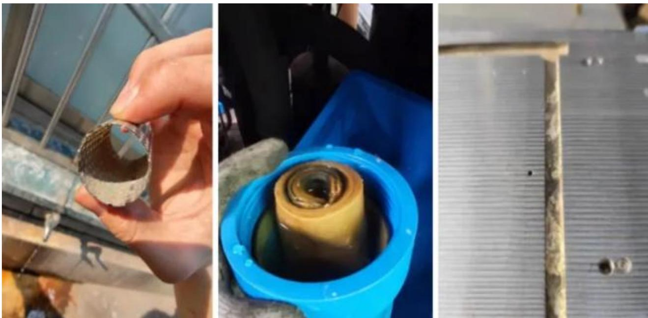
Загрязненные фильтры, фильтрующие элементы и лазерные каналы
