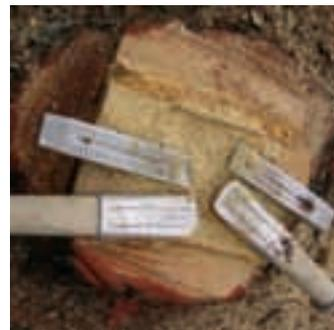
■ Используйте клинья для предотвращения падения дерева в обратную от подпила сторону и зажимания шины в резе.
