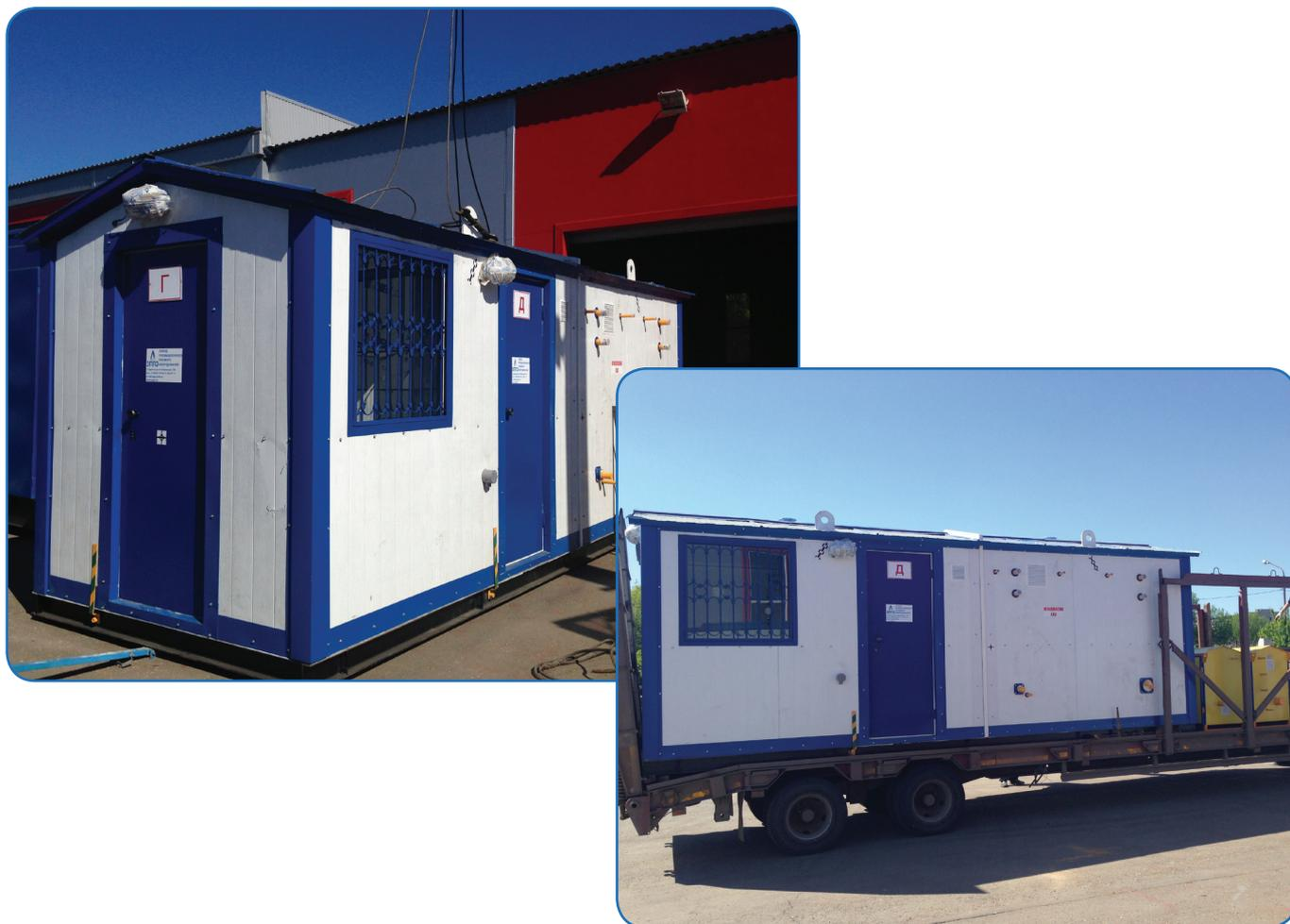
ГРПБ применяются для редуцирования высокого или среднего давления на требуемое, автоматического поддержания заданного выходного давления независимо от изменения расхода и входного давления, автоматического отключения подачи газа при аварийных повышении и понижении выходного давления сверх допустимых значений, а также для коммерческого учета расхода газа.
