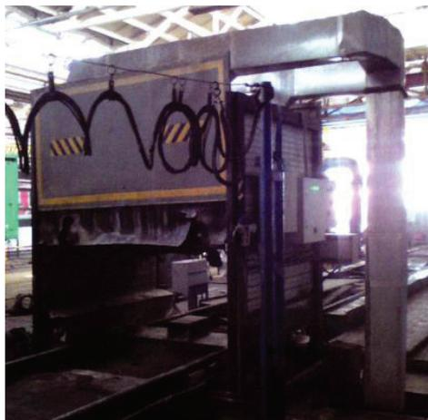
Назначение: Машина предназначена для обмывки колесных пар (без букс) от отработанной смазки и грязи.
