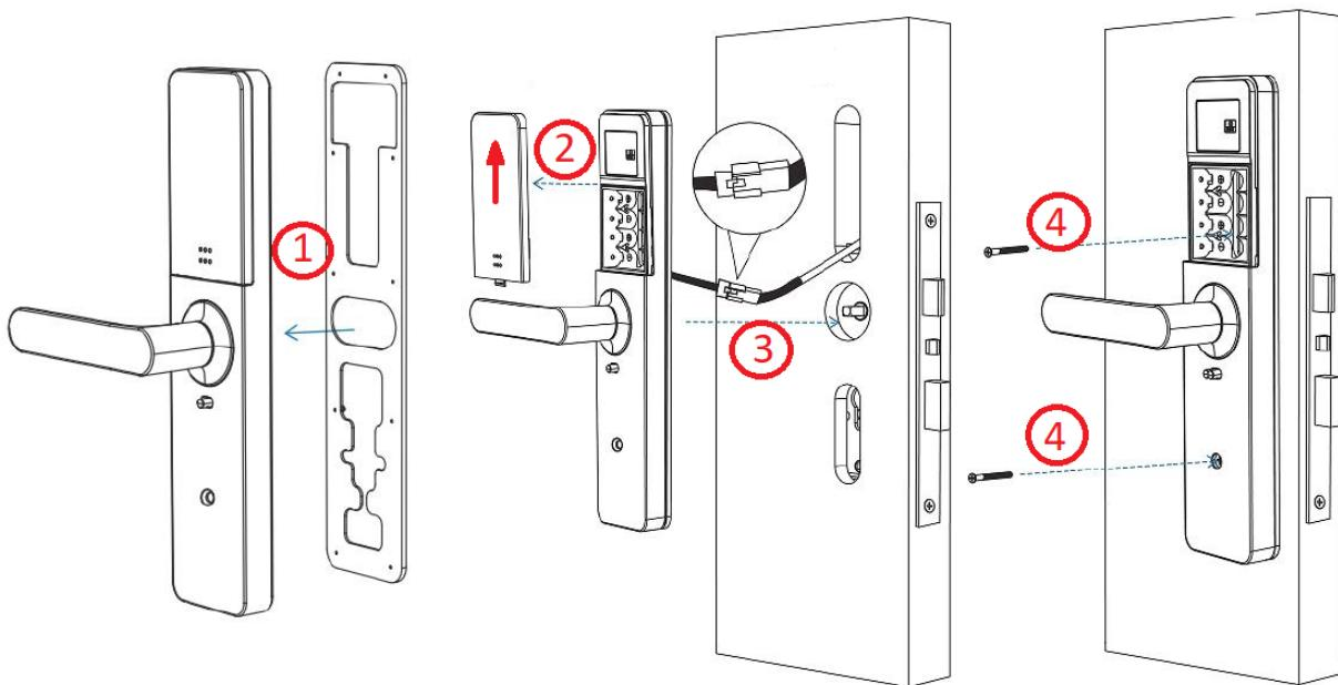
1. Закрепите на задней крышке резиновую прокладку, вставляя «грибки» в отверстия и нажимая на них для фиксации в задней крышке.
