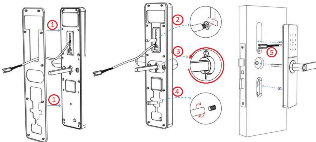
1. Закрепите на задней крышке резиновую прокладку, вставляя «грибки» в отверстия и нажимая на них для фиксации в задней крышке.
