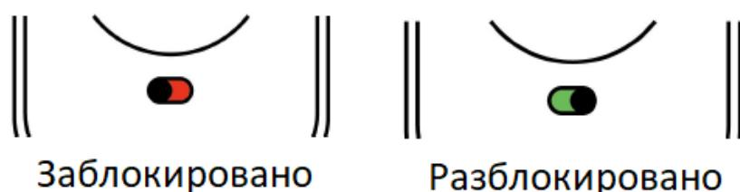
Для блокировки открывания замка снаружи электронным способом передвиньте переключатель блокировки влево. Замок сообщит о том, что блокировка включена.
