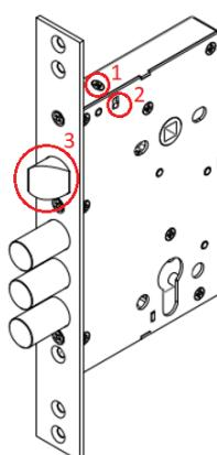
Перед началом установки проверьте соответствие установки скошенного ригеля механического замка направлению закрывания двери. Если ригель установлен неправильно, то проделайте следующее:
