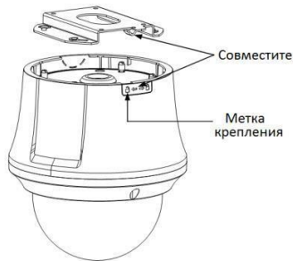
Рисунок 1-27 Накладная установка камеры
