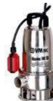
Погружные насосы Maxima применяются для дренажа котлованов, откачивания бытовых сточных вод, осушения затопленных помещений, а также для перекачивания чистой воды из колодцев и резервуаров. Рабочее колесо типа VORTEX позволяет насосам данной серии перекачивать жидкость с твердыми частицами до 30 мм без опасности засорения. Отличительной особенностью модели Maxima 300 SX является нижняя часть корпуса изготовленная из нержавеющей стали, что продлевает срок службы насоса.
