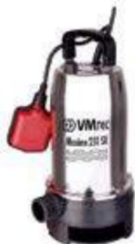
Погружные насосы из нержавеющей стали Maxima применяются для дренажа котлованов, откачивания бытовых сточных вод, осушения затопленных помещений, а также для перекачивания чистой воды из колодцев и резервуаров. Рабочее колесо типа VORTEX позволяет насосам данной серии перекачивать жидкость с твердыми частицами до 25 мм без опасности засорения. Весь ряд моделей данной серии оснащен поплавковым выключателем для автоматической работы и комплектом патрубков для соединения со шлангом
