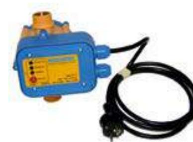
Блок автоматического управления насосами Presscontrol представляет собой устройство, позволяющее автоматизировать работу насоса. Запуск и остановка насоса происходит при изменении давления в системе, т.е. пуск насоса происходит при открытии крана, а остановка при закрытии. Presscontrol, обладая качествами современных электронных устройств, позволяет заменить традиционную систему с гидробаком. В блок автоматики встроена защита от работы насоса без воды, так называемый «сухой ход»
