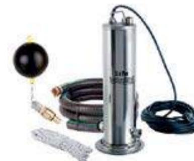
Моноблочные многоступенчатые погружные насосы из нержавеющей стали для подачи чистой воды из колодцев и резервуаров. EJ 6 это система с плавающими рабочими колесами в комплект которой входит водозаборный шланг и обратный клапан с поплавком. Насос специально разработан таким образом, чтобы водозабор происходил не со дна водоема а приблизительно к поверхности. Такая комплектация пригодится при условии загрязненного дна водоема.
