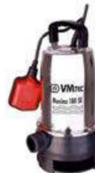
Погружные насосы из нержавеющей стали Maxima применяются для откачивания бытовых сточных вод, осушения затопленных помещений, а также для перекачивания чистой воды из колодцев и резервуаров. Рабочее колесо типа VORTEX позволяет насосам данной серии перекачивать жидкость с твердыми частицами до 25 мм без опасности засорения. Отличительной особенностью модели Maxima 180 SX является нижняя часть корпуса изготовленная из ударопрочного пластика, что значительно уменьшает вес насоса.
