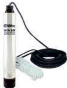
Глубинные насосы серии AJ 4 Plus выполнены из нержавеющей стали. Они подходят для подачи воды из колодцев и скважин с небольшим диаметром от 10 см. Запатентованная гидравлическая система насосов AJ 4 позволяет перекачивать воду с большим количеством песка до 50 гр на м<sup>3</sup>. Встроенный обратный клапан и диффузоры с керамической вставкой в точке износа делает эти насосы долговечными и удобными в использовании.
