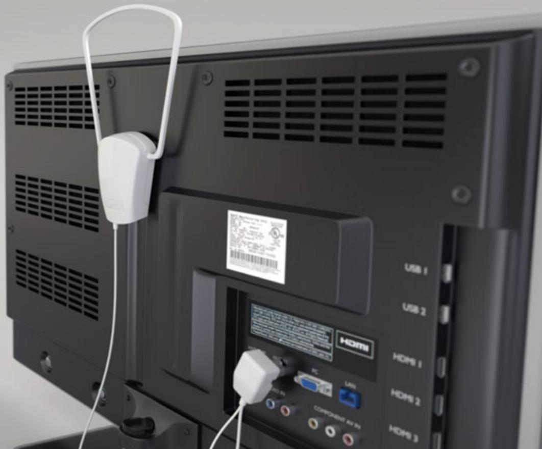
Кроме традиционных способов установки, встроенные в заднюю стенку антенны присоски позволят закрепить ее на любой подходящей гладкой поверхности – оконное стекло, заднюю стенку телевизора, полированную мебель и другие.
