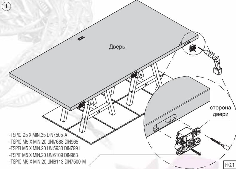
\*Установить дверь на дверной коробке, поместив петли в соответствующие пазы (рис.2). Зафиксировать петли предназначенными шурупами.
