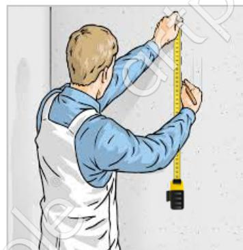
Разметьте стену, используя строительный или лазерный уровень в соответствии с выбранной раскладкой, учитывая расположение световых профилей.
