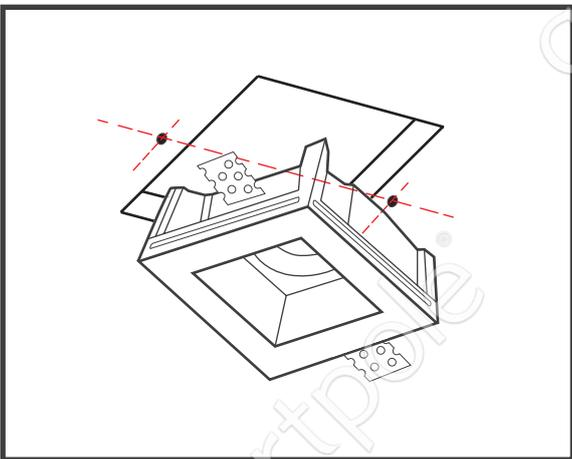
6. Через намеченные точки вкручиваются саморезы, которые, пройдя через гипсокартон, фиксируются в соответствующих отверстиях монтажных пластин.
