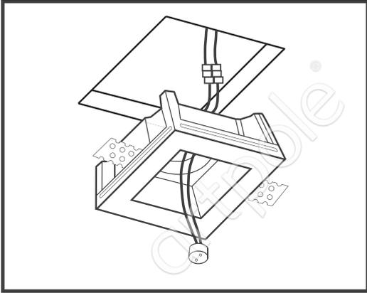
4. После этого светильник накладывается на нишу, центрируется, и карандашом намечаются места вкручивания саморезов - по одному на каждую монтажную пластину.
