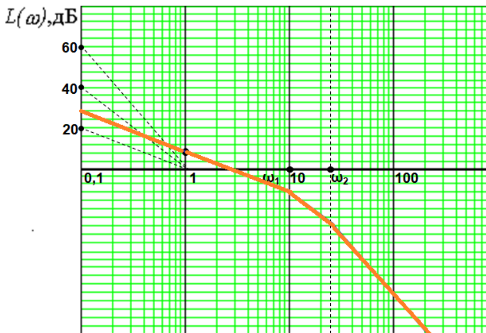
Рисунок 1. Асимптотическая ЛАЧХ САУ L(\omega)
