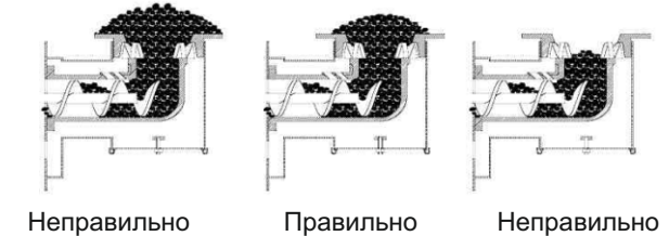
Правильный вид горелки при сгорании пеллеты
