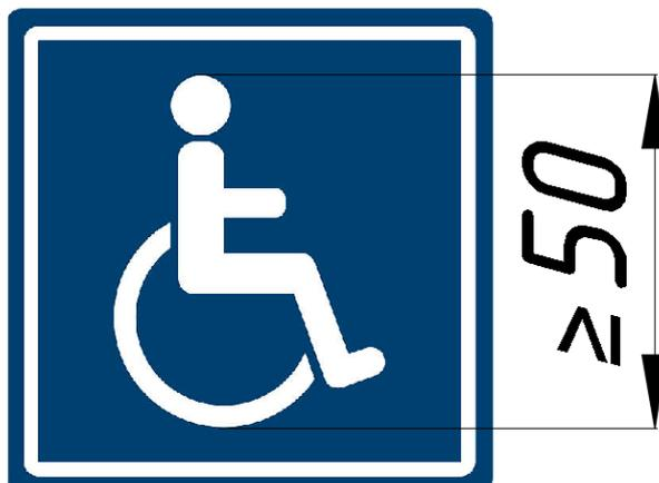
На грузонесущем устройстве и на нижней посадочной площадке рядом с пультом управления должна быть табличка со следующей информацией о подъемной платформе:
