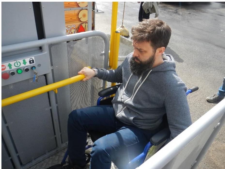
7. После въезда на платформу Пользователь приводит стояночный тормоз кресла-коляски в активное положение в соответствии с правилами безопасности (рис.9).
