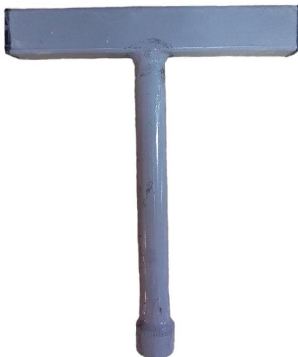
После устранения причин нештатной ситуации необходимо вернуть в рабочее состояние тормоз электродвигателя, выкрутив вышеуказанный болт до момента включения контрольной лампы.
