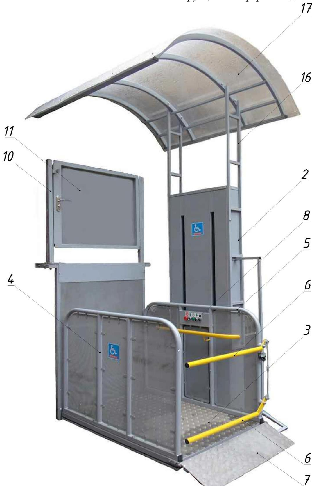
Условные обозначения: 2 - приводная колонна, 3 - горизонтальная площадка, 4 - ограждение грузонесущего устройства внешнее, 5 - ограждение грузонесущего устройства внутреннее, 6 - шлагбаумы, 7 - пандус, 8 - панель управления, 10 - ограждение этажной площадки, 11 - дверь (калитка) ограждения этажной площадки, 16 - крепление защитного навеса (козырька), 17 - защитный навес (козырек);
