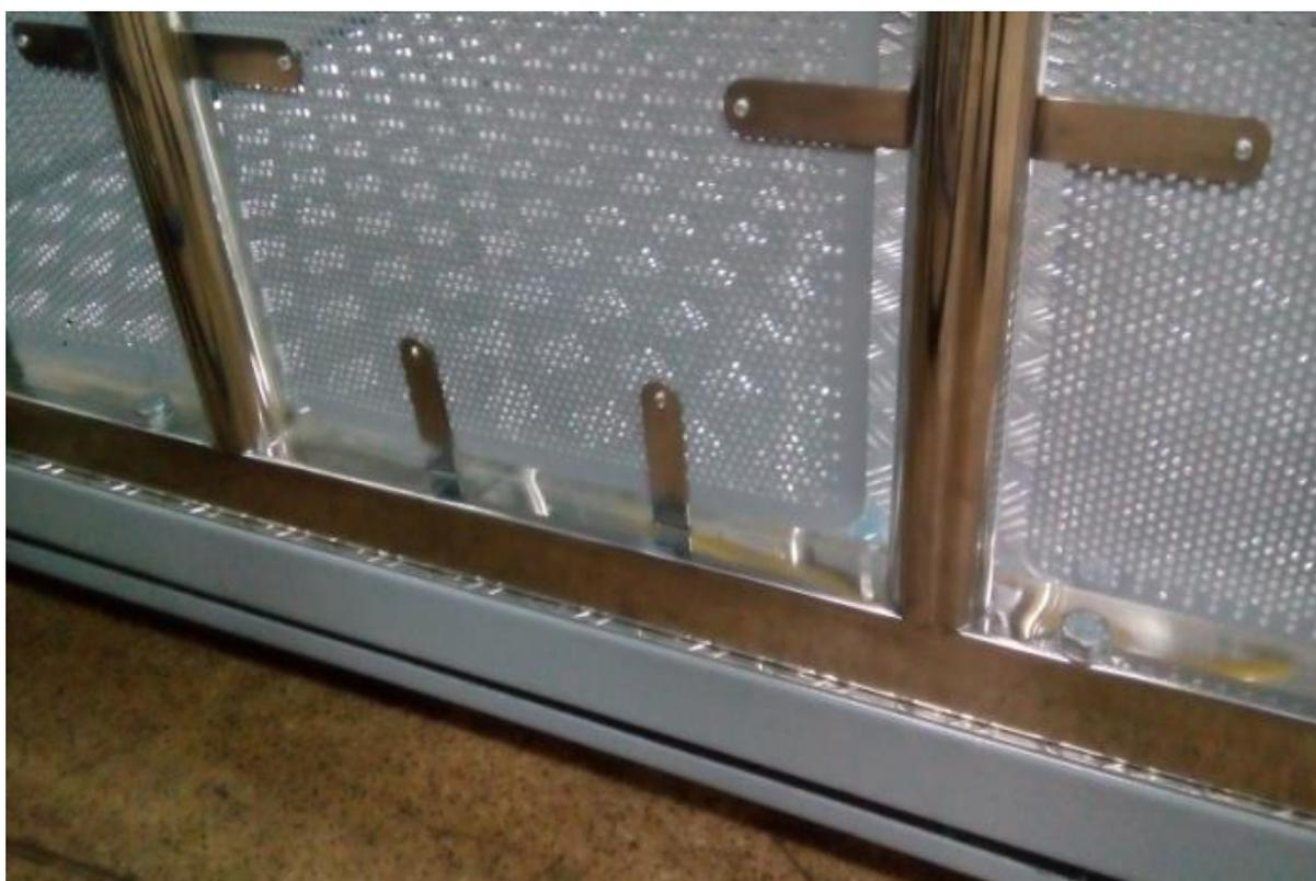
14. Далее необходимо установить въездной подъемный пандус используя «петли», сверлоконечные саморезы 6,5x25 (рис. 10) и шайбы Ø12x24 (рис. 11). При выполнении данной процедуры необходимо соблюсти
