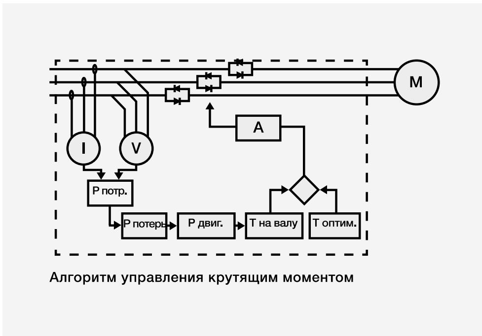
При управлении крутящим моментом постепенно снижается не напряжение, а крутящий момент. При этом двигатель сразу же замедляется, управляемое замедление выполняется вплоть до полного останова, см. рисунок справа.
