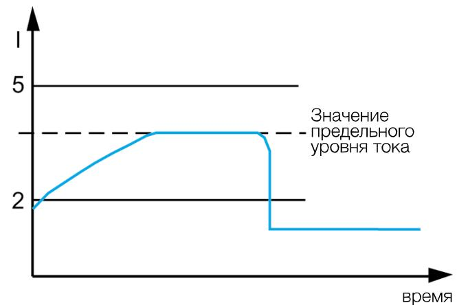
Функция ограничения пускового тока в устройствах плавного пуска ограничивает ток на предварительно заданном уровне
