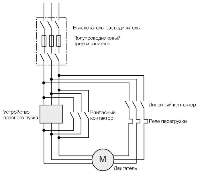
Пускатель внутри треугольника и предохранители в линии
