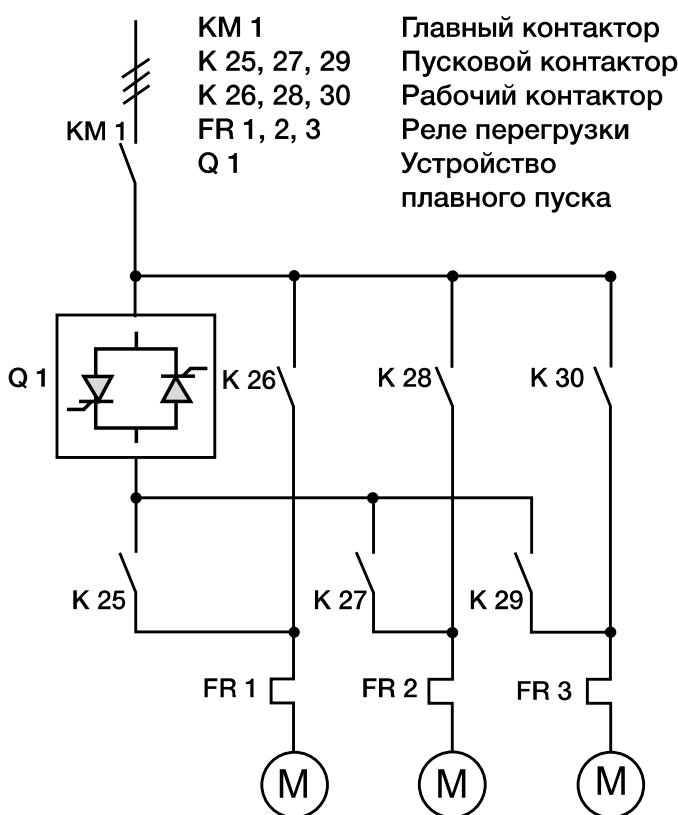
Последовательный пуск двигателей с помощью устройства плавного пуска
