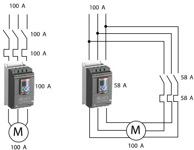
Устройство плавного пуска при подключении в линию
