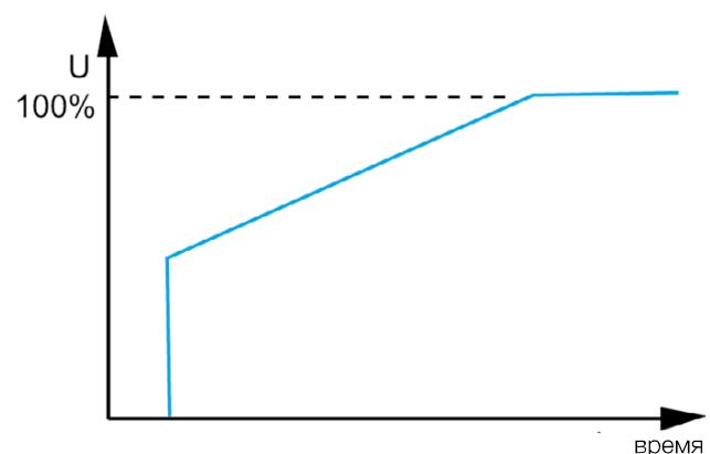
Так как напряжение на двигателе во время пуска уменьшается, ток и крутящий момент также снижаются. Если напряжение снижается до 50 % от полного значения, ток снизится приблизительно до 50 % от максимального значения на этой скорости, а крутящий момент — приблизительно до 25 %.
