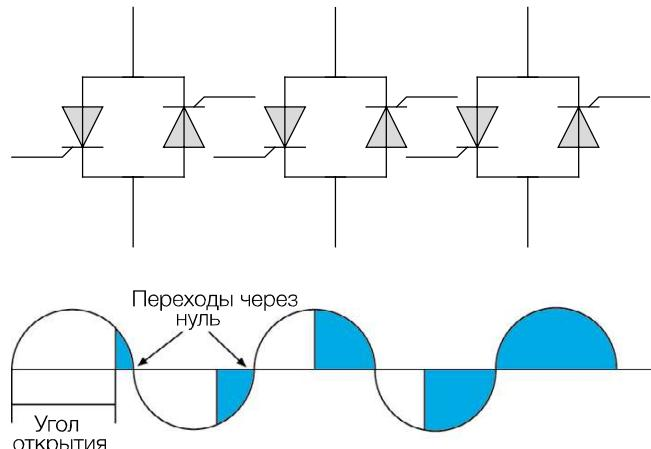
**Пуск:** В начале тиристоры пропускают часть напряжения, а затем увеличивают его в соответствии с установленным временем разгона.
