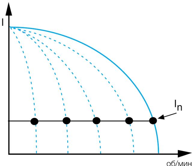
Частотный преобразователь даже во время пуска работает на номинальном токе и крутящем моменте
