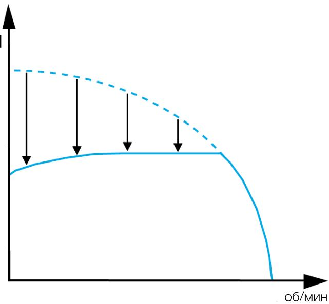
Ток и напряжение необходимо дополнительно снизить в начале пуска
