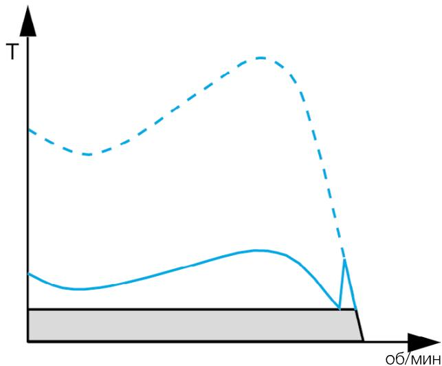
График зависимости крутящего момента от скорости при использовании пускателя со схемой соединения звезда/треугольник с низким уровнем момента сопротивления
