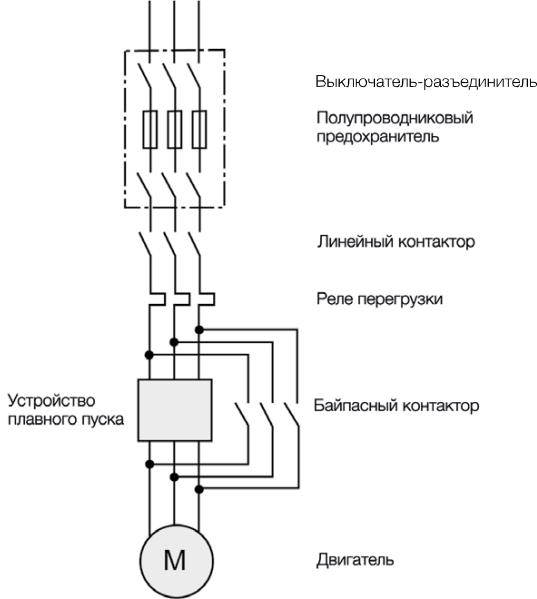
Пускатели и предохранители в линии
