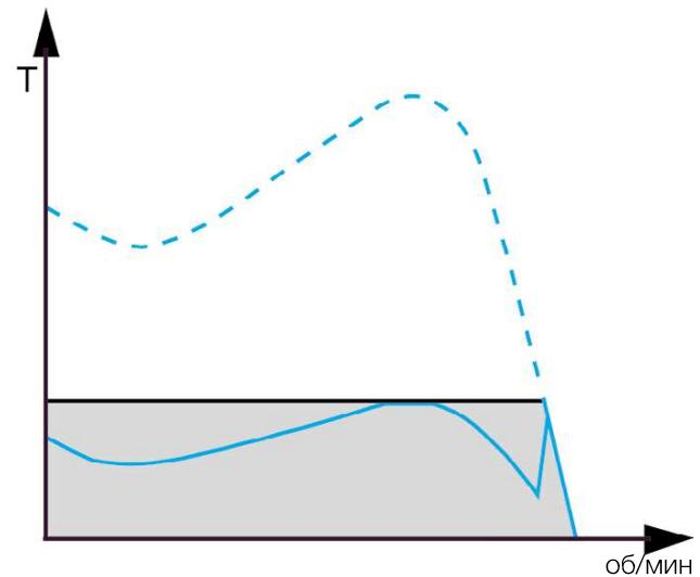
График зависимости крутящего момента от скорости при использовании пускателя со схемой соединения звезда/треугольник с высоким уровнем момента сопротивления
