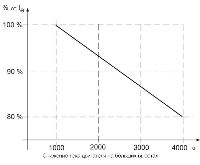
Снижение тока двигателя на больших высотах
