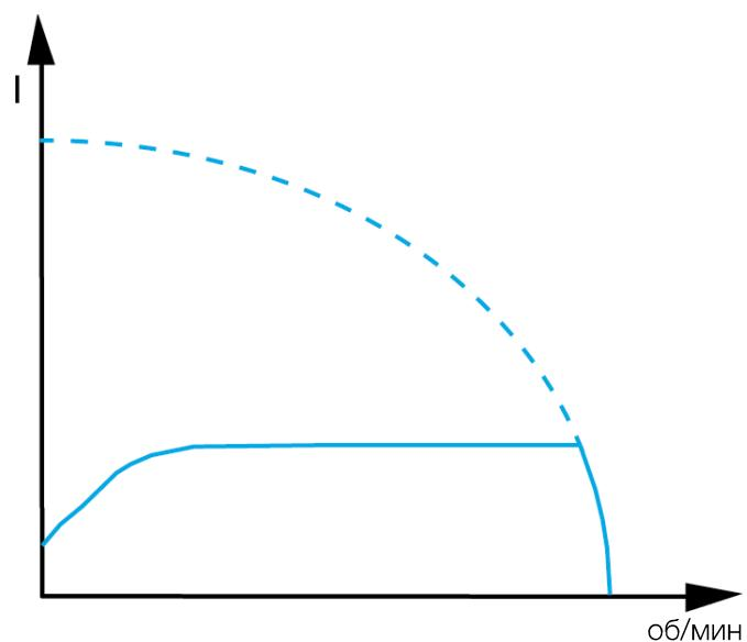
Кривые крутящего момента и тока при запуске слабо и сильно загруженного двигателя с помощью устройства плавного пуска
