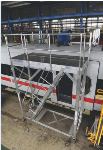
Мобильная ремонтная площадка
