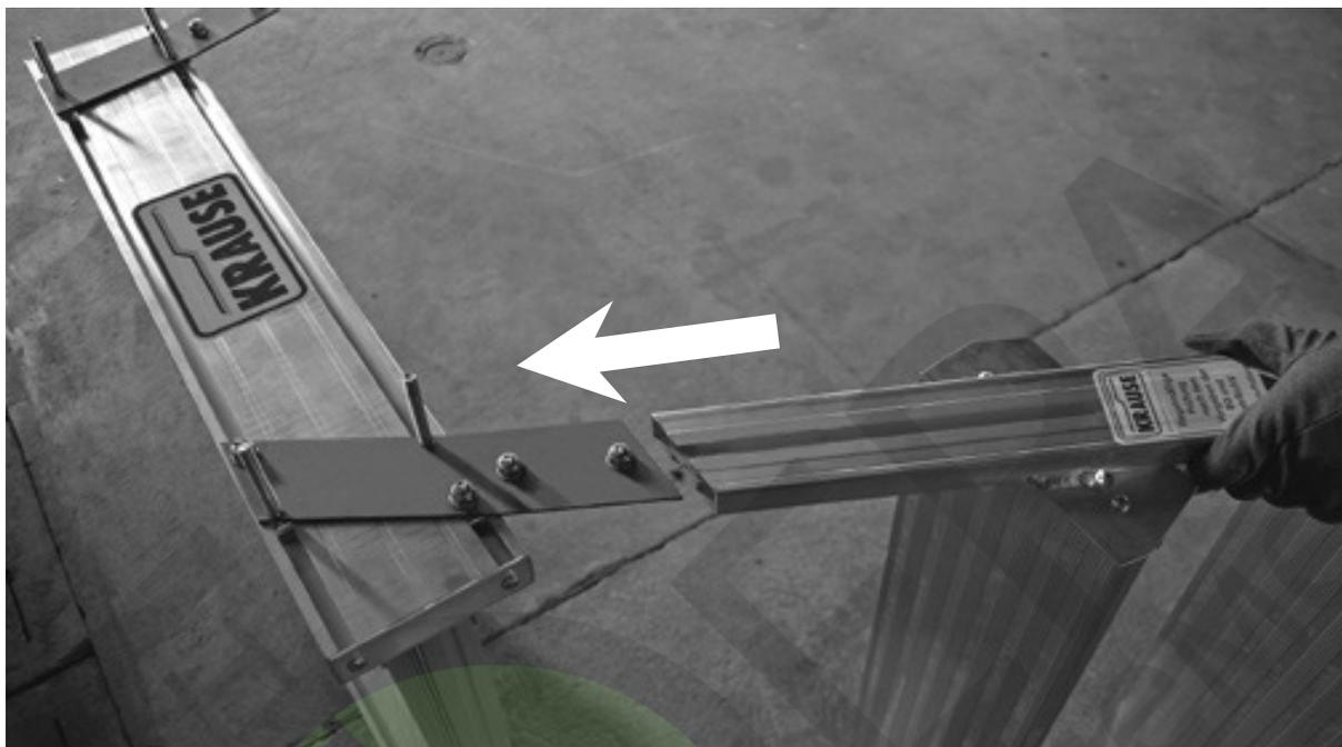
Положите помост боком «на ребро», и вставьте лестничную часть в соединительные планки. Затяните гайки рукой. Обратите внимание на то, чтобы желобок на болте находился под углом  $90^\circ$  к соединительному каналу боковины лестничной части (см. картинку ниже).
