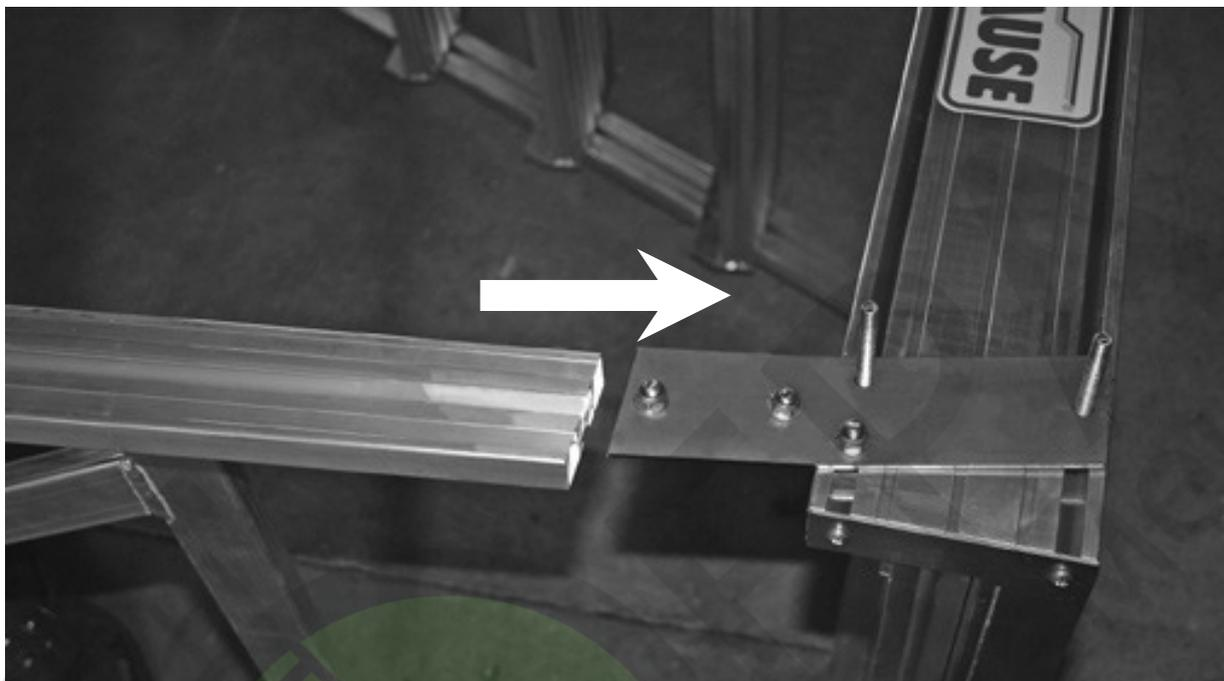
Вставьте опорную часть (у односторонней лестницы с платформой) в соединительные планки. У двусторонней лестницы вместо опорной части устанавливается вторая лестничная часть. Затяните гайки рукой.
