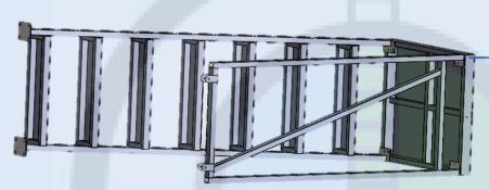
2. Лестничный марш и стойку соединяем горизонтальными связями. Узлы группы В соединяются четырьмя шестигранными болтами (по одному на каждый узел) М6 70мм.
