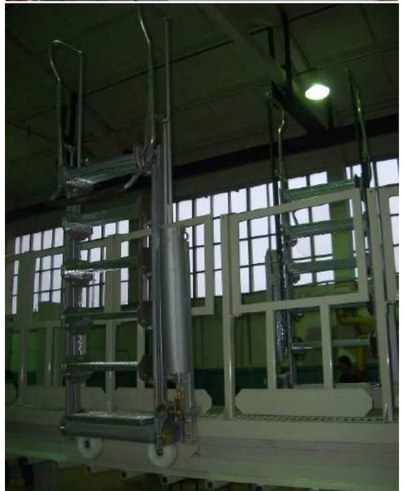
*Перекидной трап для с возможностью перемещения вдоль оси эстакады*
