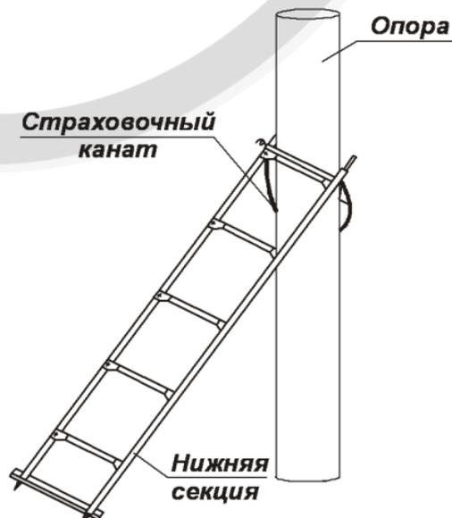
Далее устанавливают нижнее звено в вертикальное положение. При этом опорный уголок должен полностью опираться на поверхность почвы, а острия упоров должны быть утоплены в землю.
