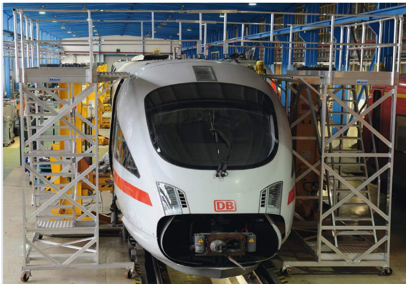
Монтажная мобильная площадка, внутренние лестницы, складывающиеся ограждения для соединения двух площадок
