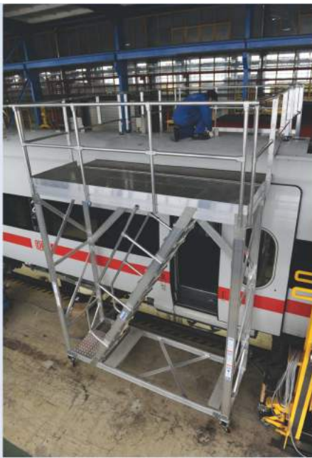
Мобильная ремонтная площадка
