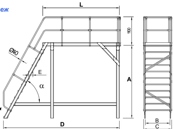
дополнительная планка для колен при наклоне 45 град
