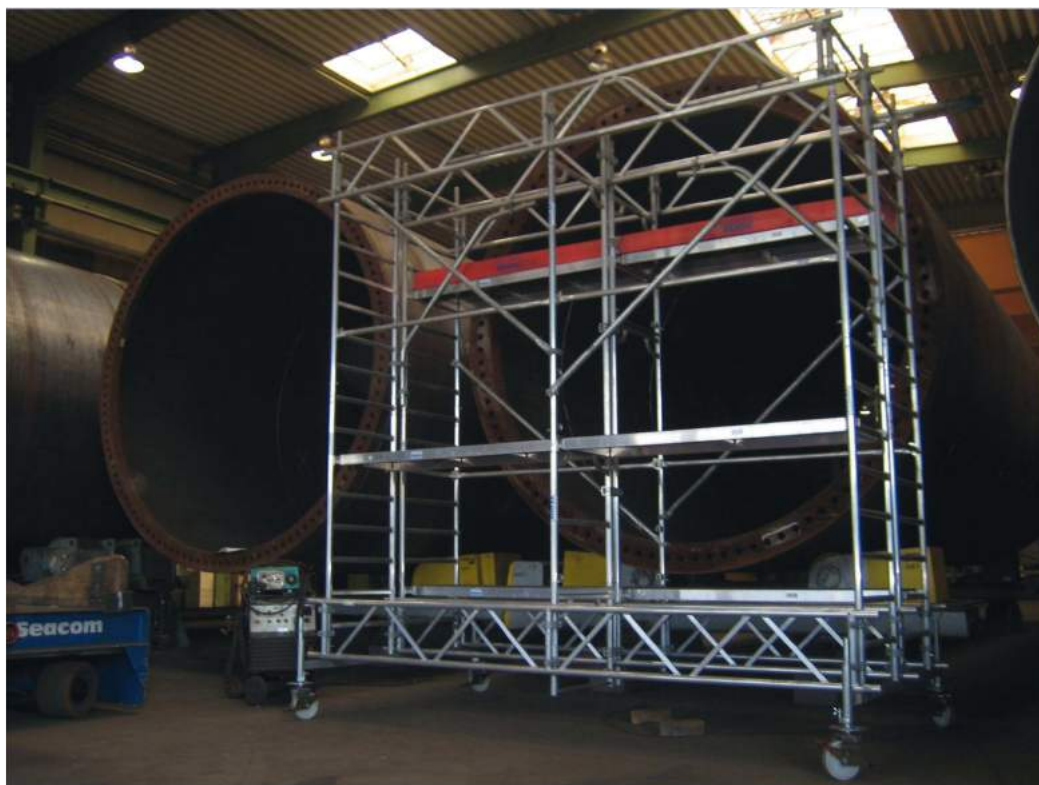
Рабочая вышка, передвижная, вкл. крепления для перемещения при помощи крана
