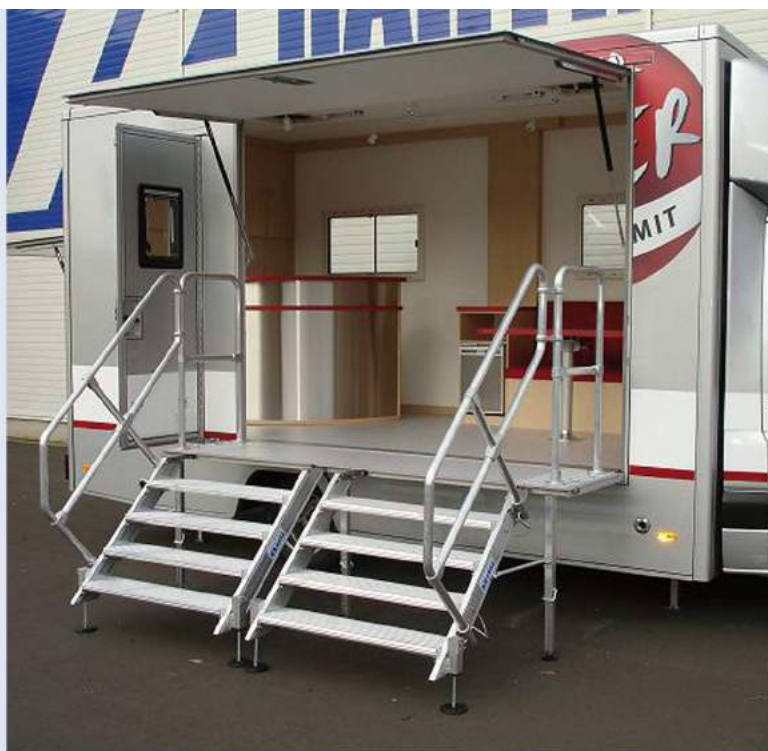
Трап стационарный, регулируемый по высоте, со съемными перилами
