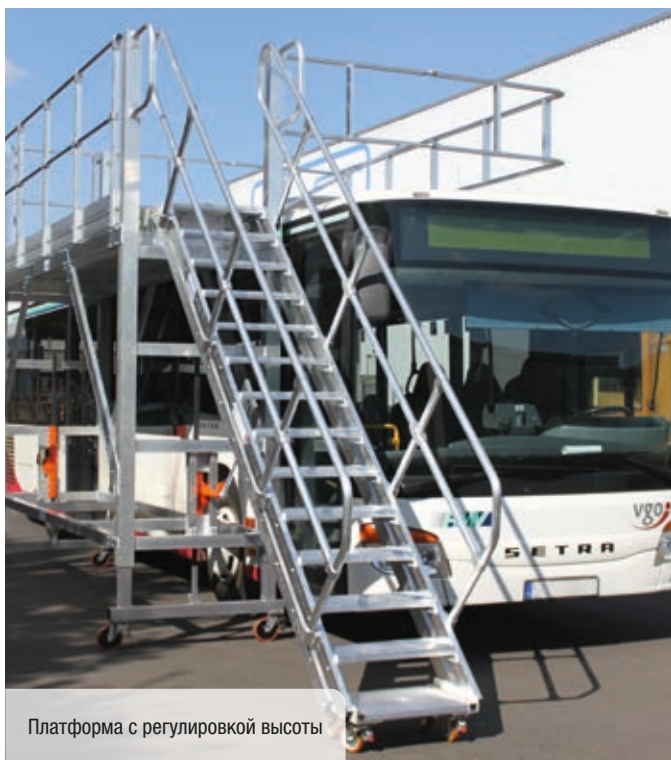
Мобильная монтажная платформа со складным ограждением
