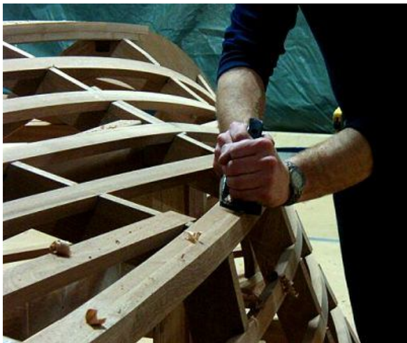
Малковка скулового стрингера ручным рубанком
