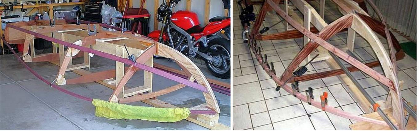
Днищевые стрингера изготавливают отдельно и затем врезают в набор. Чтобы изогнуть передний конец 2 днищевого стрингера на нем делают 5 продольных сквозных пропилов на длину 1.2метра, промазывают пропилы клеем, а затем изгибают на шаблоне. После высыхания обрабатывают в чистый размер. (чертеж «Стрингера днищевые2»). Передняя часть 2 днищевого стрингера вклеивается встык со скуловым стрингером, задняя врезается в глухой шип в обвязку транца.
