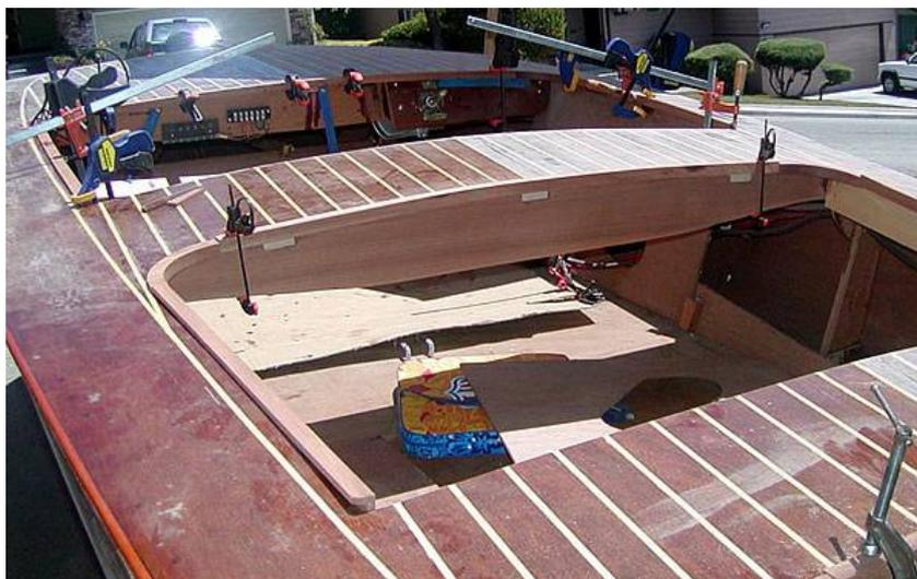
3. Пайолы. Пайолы кокпитов укладываются на стрингера, флоры и опорные рейки на диванах. Боковые панели пайолов крепятся к стрингерам флорам на клею и шурупах, а к обшивке борта на галтелях из эпоксидного компаунда.
