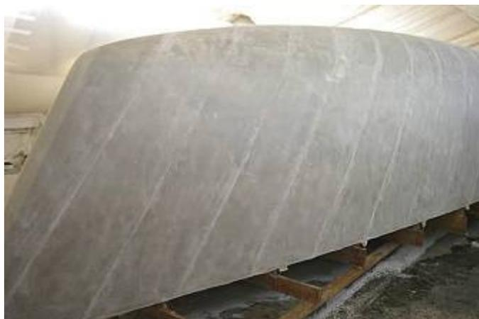
оказывается на теплой древесине, она нагревается, теряет вязкость, и успевает проникнуть достаточно глубоко в древесину до охлаждения и начала полимеризации. При таком способе (нагрев древесины вместо смолы) вы получаете два преимущества: на рабочей поверхности смола будет более жидкая и хорошо пропитывает ткань, а смесь смолы с отвердителем в емкости обладает дольше жизнеспособностью.
