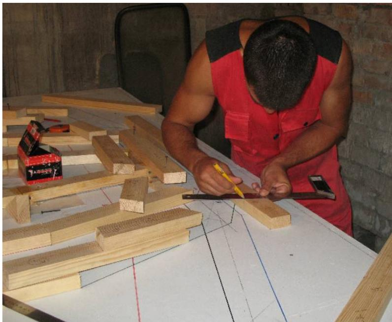
Рис 2. Разметка тимберсов шпангоута на плазе
