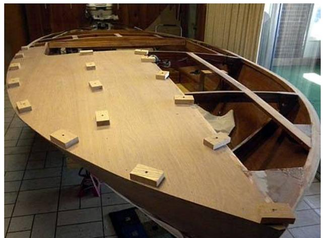
шурупов около 75мм. Стыковка фанерных заготовок палубы по длине обычно производится встык на подкладных планках из той же фанеры. Планки шириной не менее 15 толщин фанеры плотно подгоняются между палубными стрингерами.
