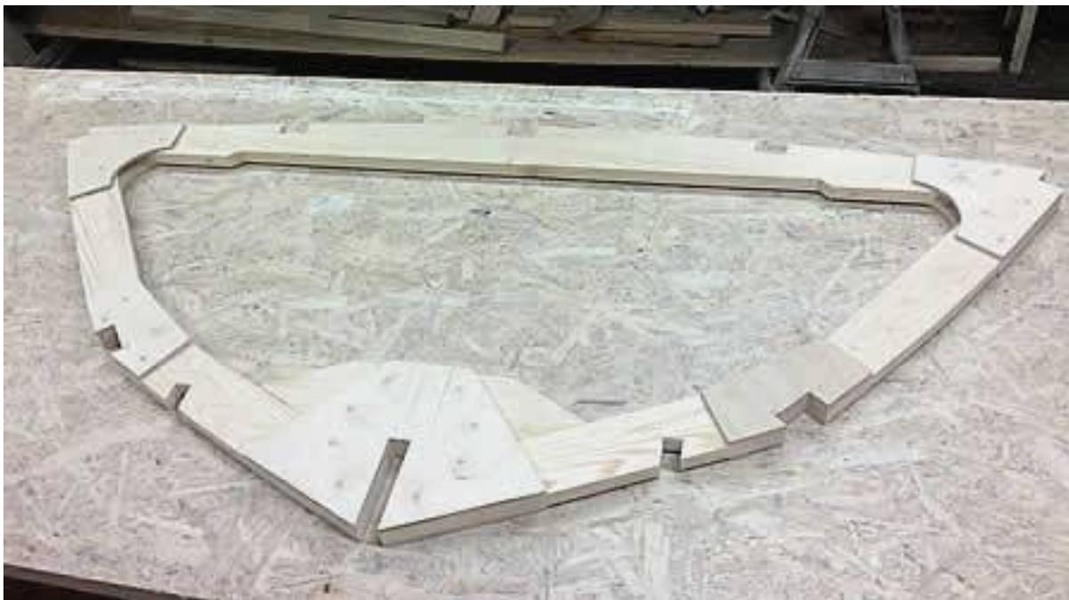
Рис. 4. Рамный шпангоут с фанерными накладками и вырезом под киль/форштевень и стрингера собран на плазе.
