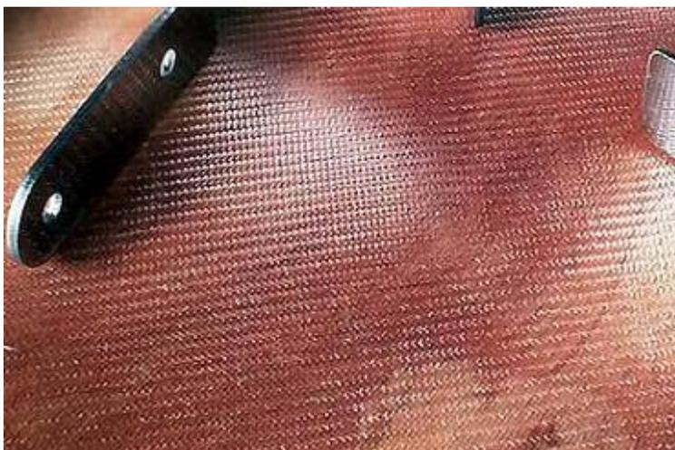
Независимо от типа стеклоткани и марки эпоксидной смолы сам процесс оклейки по существу одинаков. Не стоит бояться этого процесса: речь идет всего-навсего о том, чтобы приклеить ткань к поверхности с использованием минимального количества эпоксидной смолы. Смолы должно быть ровно столько, чтобы она только пропитала ткань, и была видна ее структура (как на рисунке слева), а заполнить текстуру
