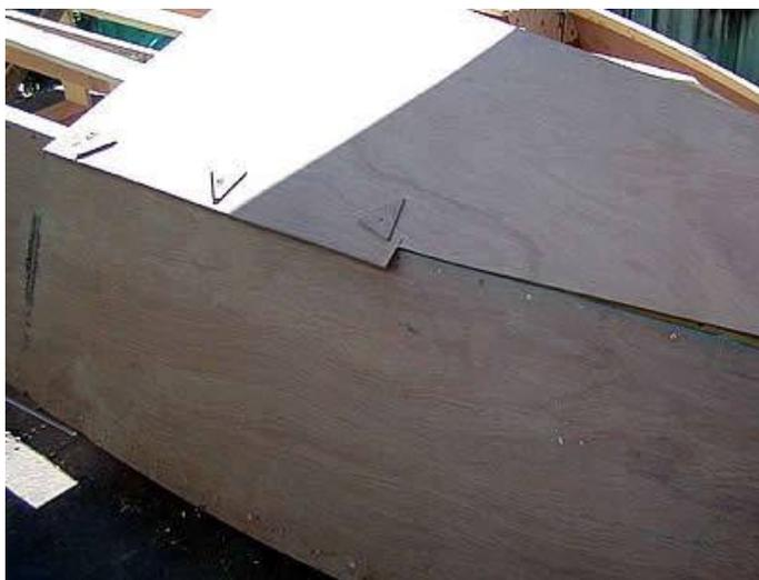
Затем переходят к обшивке днища. В кормовой и средней части обшивка днища по скуловому стрингеру идет с напуском на обшивку борта, а на расстоянии 1300мм от носа соединяется с ней встык. (См. чертеж «Обшивка днища и борта») Поэтому здесь нужно внимательно подогнать кромки по месту. См. рис. слева.
