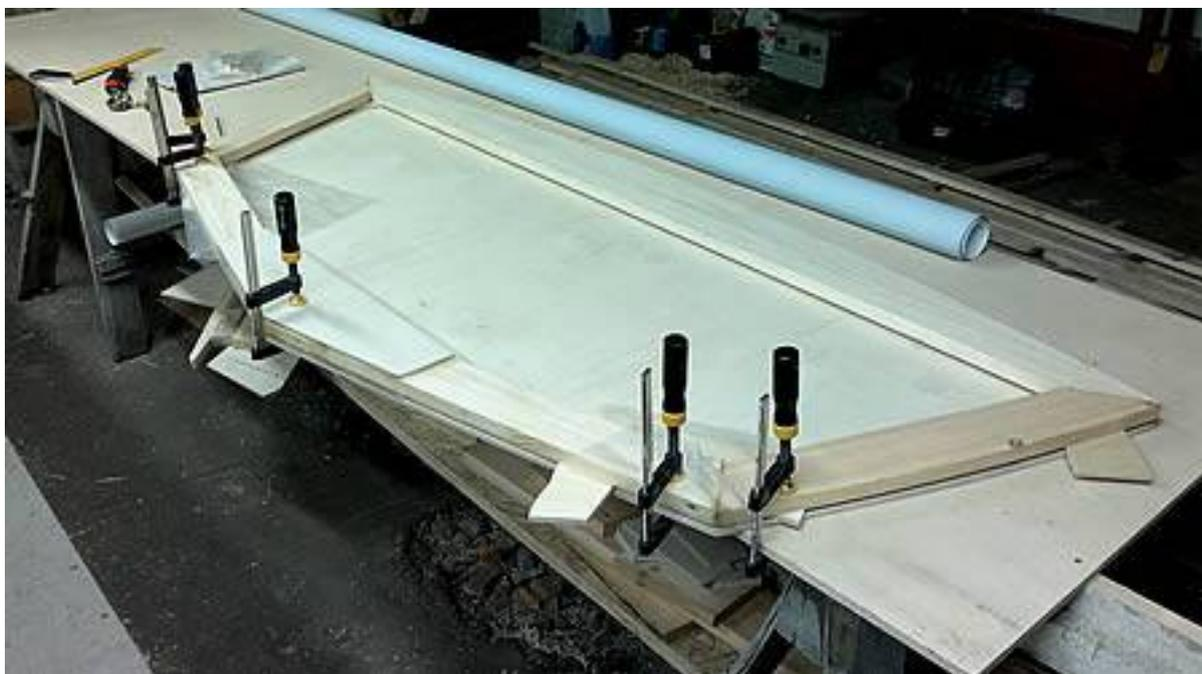
Рис.3 Сборка тимберсов в рамный шпангоут на плазе
